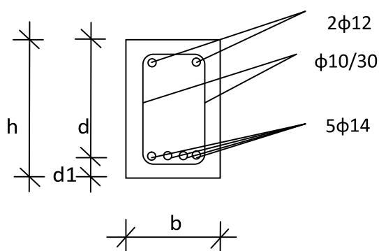
Uzdužna armatura na poprečnu silu ( $V_{Rd,c}$ ):
