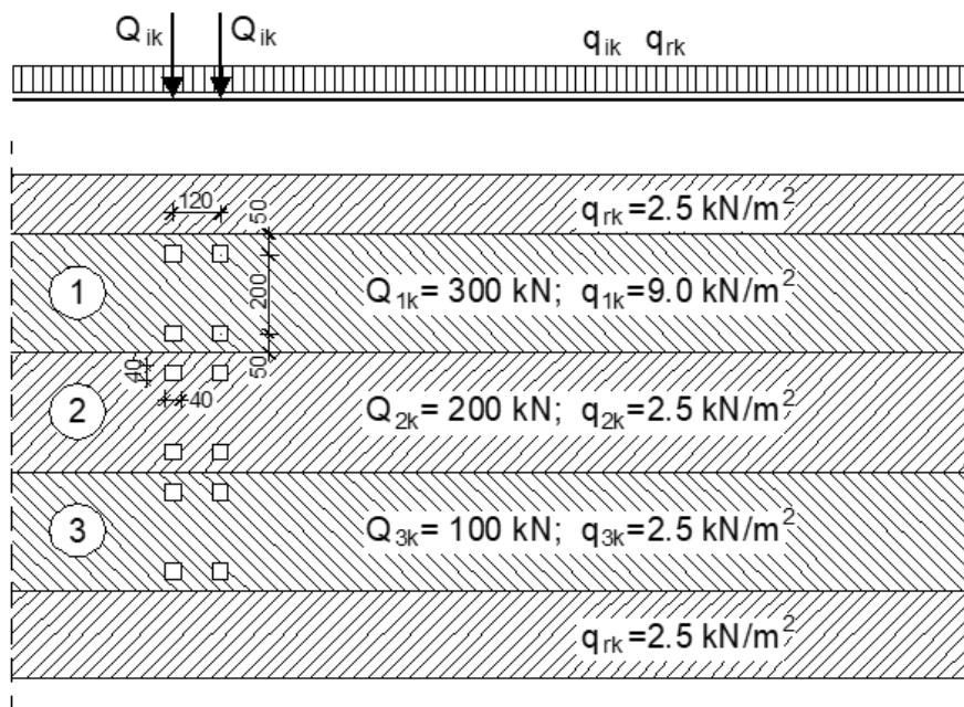
Slika 14. Prikaz načina opterećivanja mosta pokretnim opterećenjem
