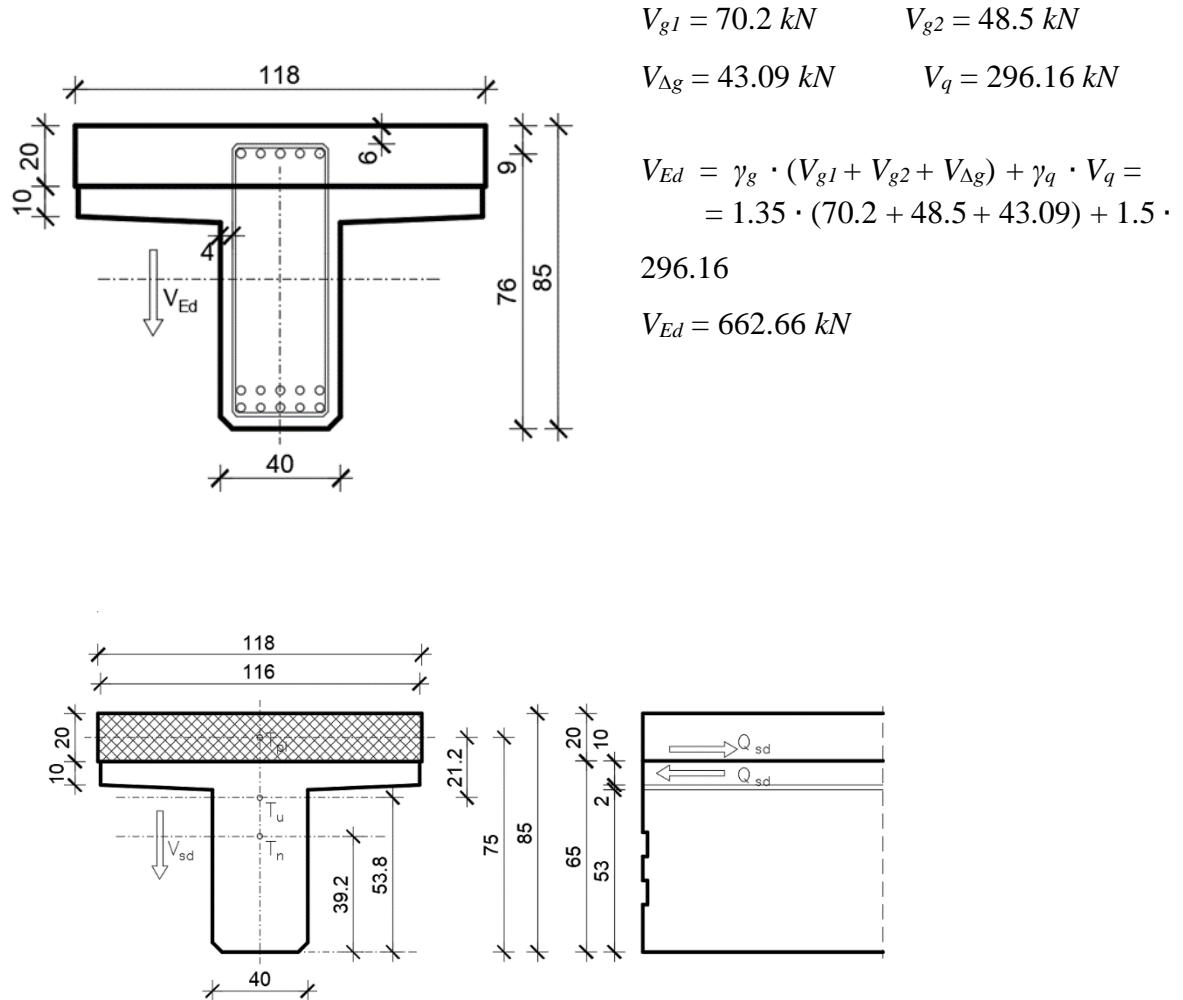
Slika 32. Poprečni presjek spregnutog T nosača
