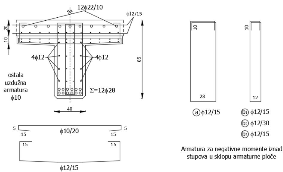
Slika 34. Prikaz armiranja nosača u presjeku
