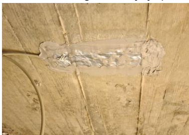
Slika 6. Mjerni senzori na betonu i prednapetom čeliku
