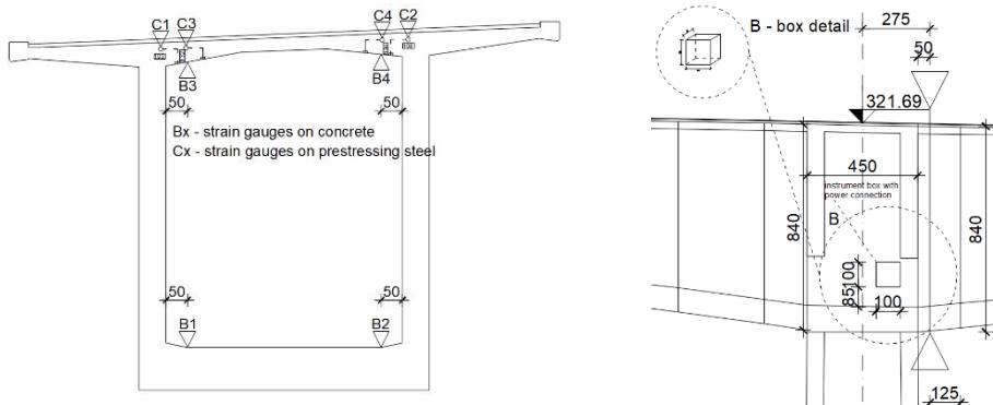
**Slika 5.** Presjek na kojem su ugrađeni mjerni senzori
