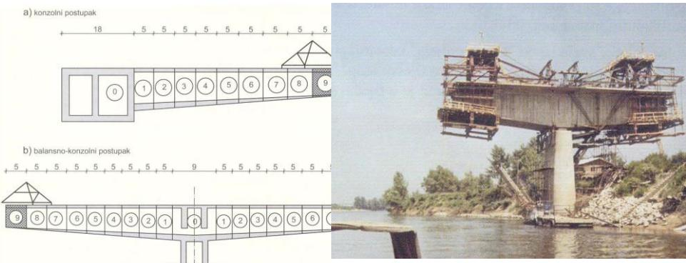
Slika 4. Princip izvedbe mostova slobodno konzolnom gradnjom
