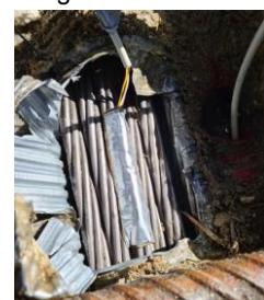
**Slika 6.** Mjerni senzori na betonu i prednapetom čeliku
