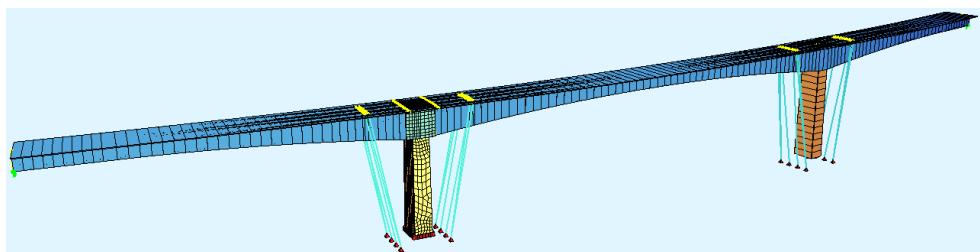
**Slika 7.** Numerički model mosta Vranduk 2 (lijevi most)
