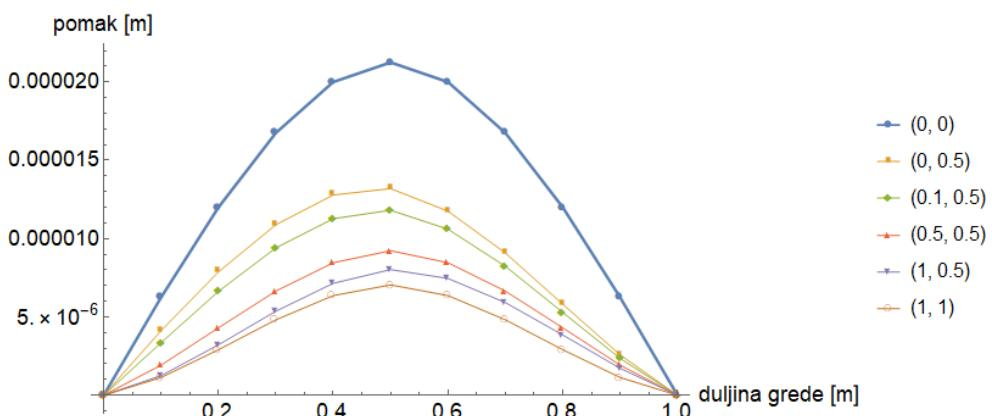
Slika 2. Utjecaj promjene parametra uklještenja lijeve i desne strane na progib grede
