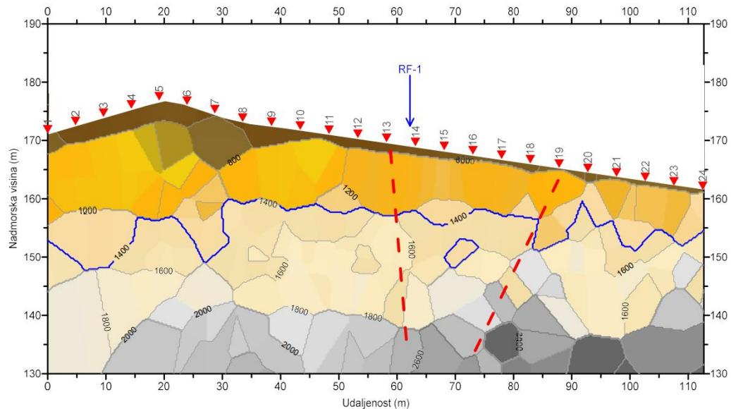
Slika 8. Dubinski seizmički presjek profila RF-4 (izlaz iz tunela) [3]
