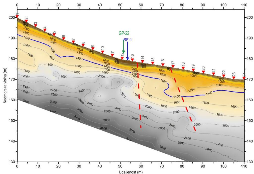
*Slika 7. Dubinski seizmički presjek profila RF-2 (ulaz u tune ) [3]*
