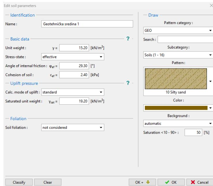
Slika 28. Parametri kohezije i tla unutarnjeg trenja za geotehničku sredinu 1
