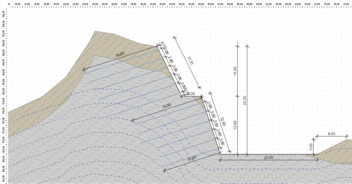
Slika 46. Geometrija presjeka na izlaznom predusjeku tunela stabilizirana sidarima
