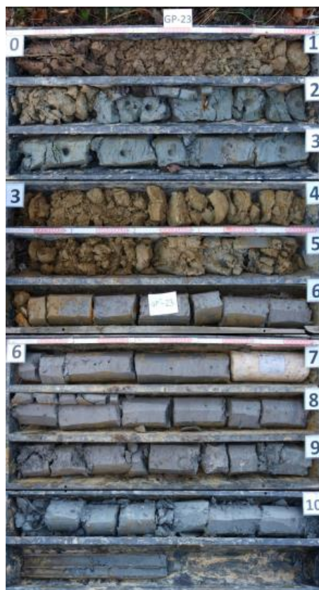
Slika 6. Fotodokumentacija jezgre bušotine GP-23 [3]
