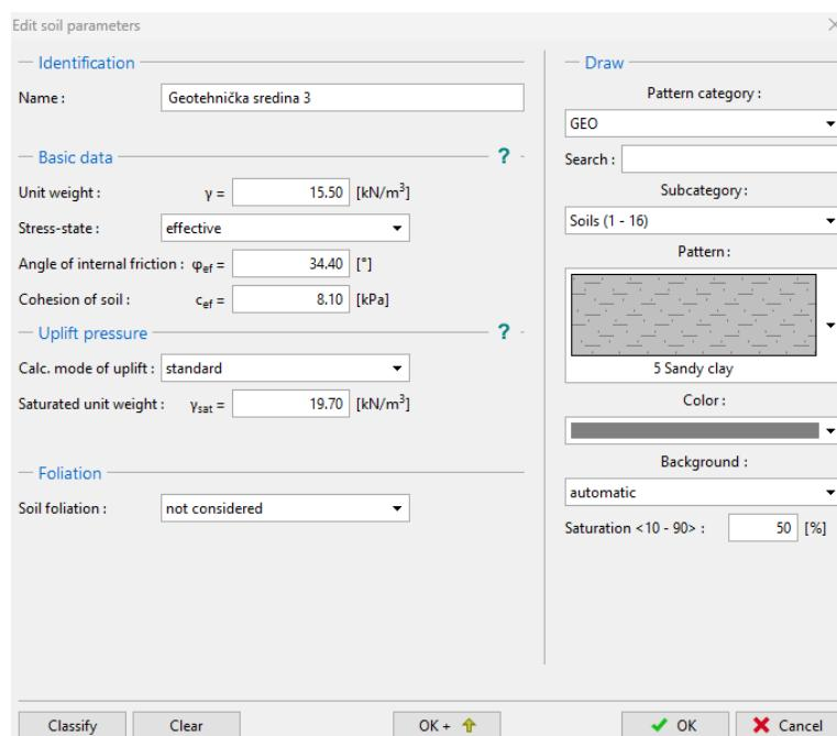
Slika 29. Parametri kohezije i tla unutarnjeg trenja za geotehničku sredinu 3
