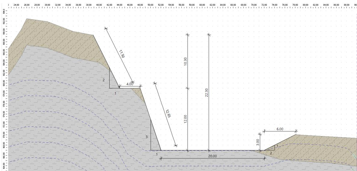
Slika 37. Geometrija zasjeka na izlaznom predusjeku tunela, Model 2
