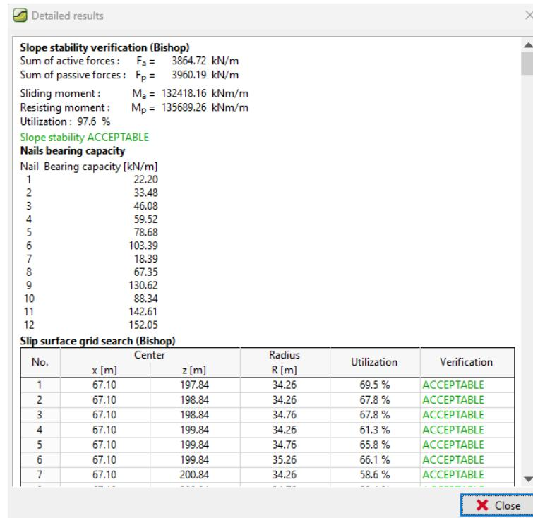
Slika 49. Nosivost štapnih sidara lijeve strane izlaznog predusjeka tunela
