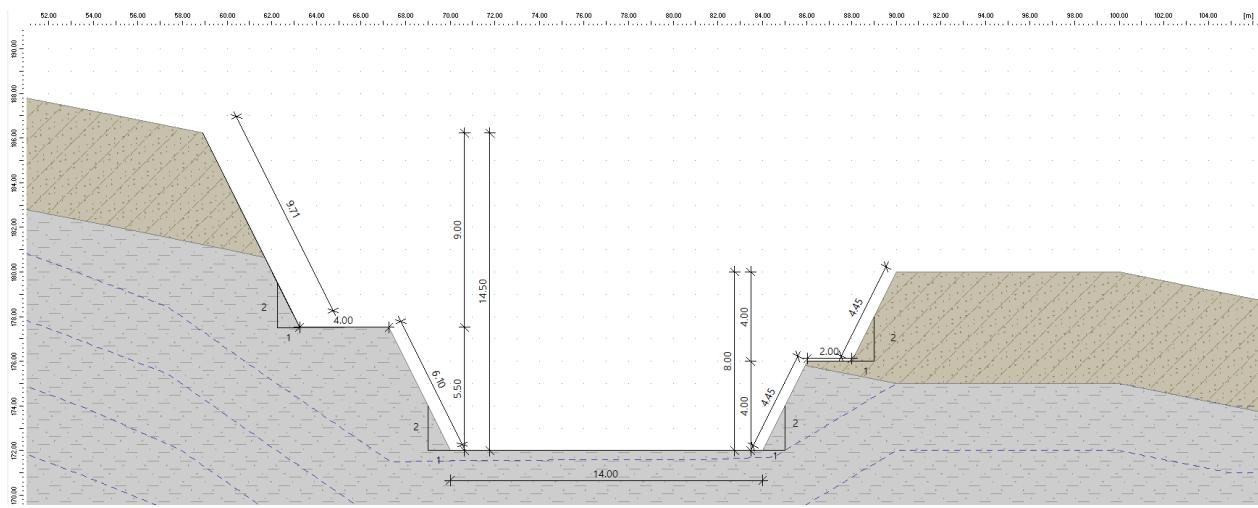
Slika 36. Geometrija zasjeka na ulaznom predusjeku tunela, Model 1
