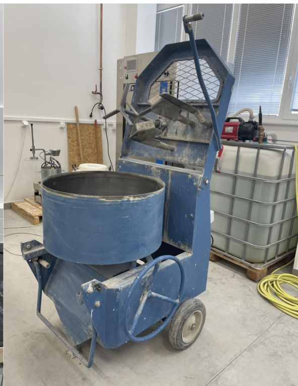
Slika 21. Laboratorijska miješalica za beton
