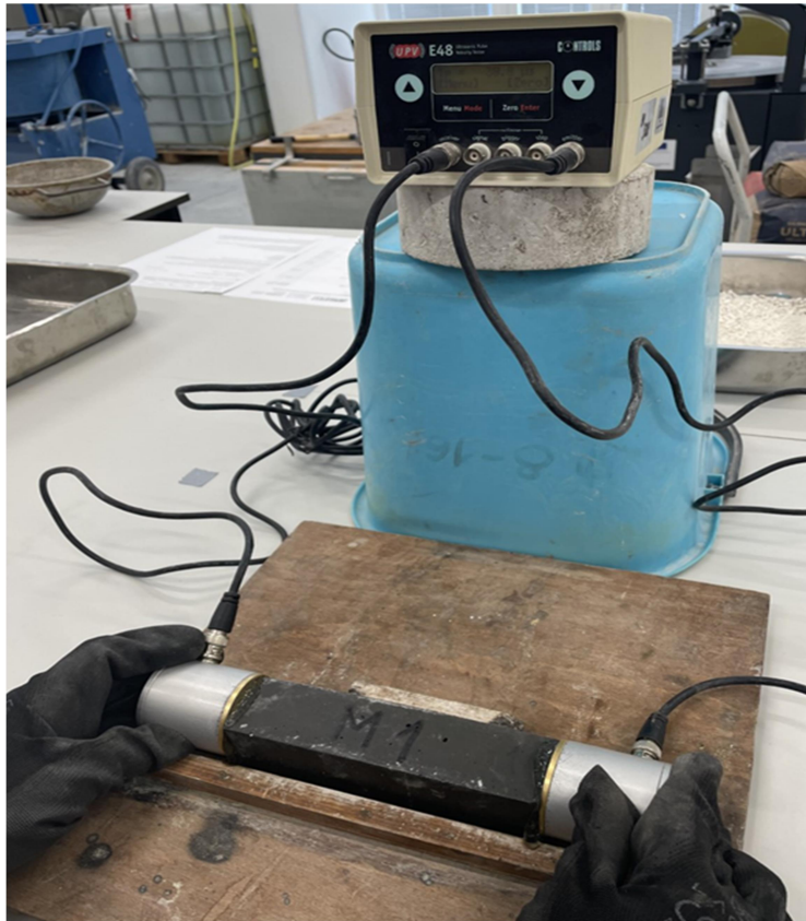
Slika 25. Ispitivanje brzine ultrazvuka
