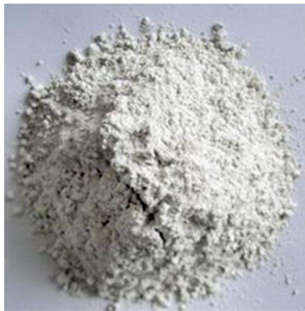
Slika 10. Granulirana zgura visoke peći [18]
