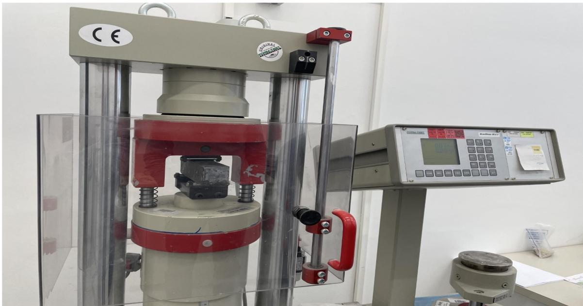
Slika 27. Ispitivanje savojne čvrstoće UHPC betona
