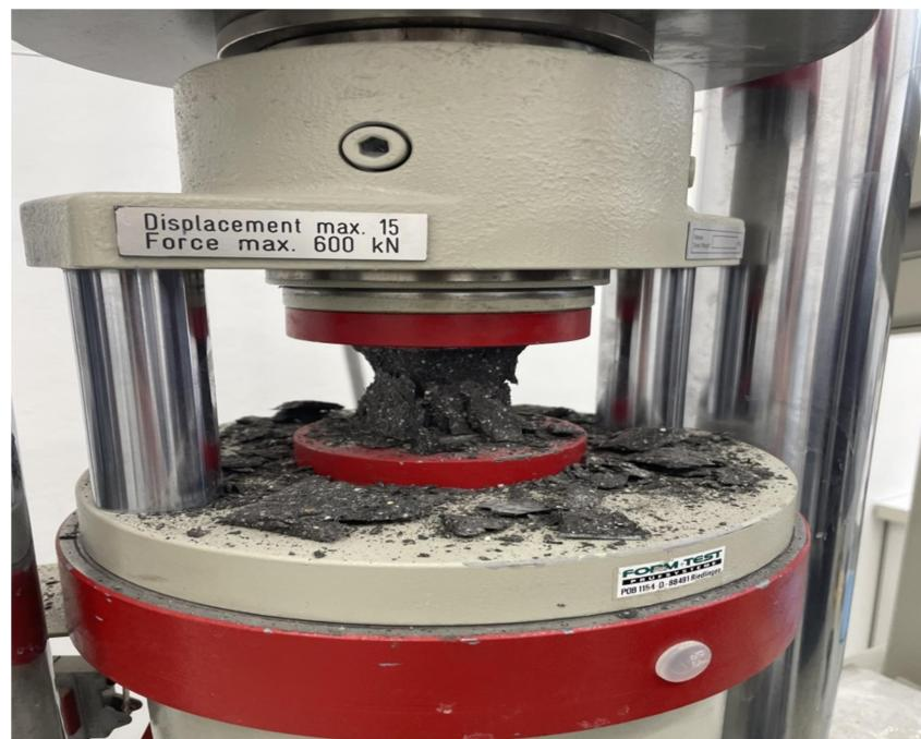
Slika 28. Ispitivanje tlačne čvrstoće UHPC betona
