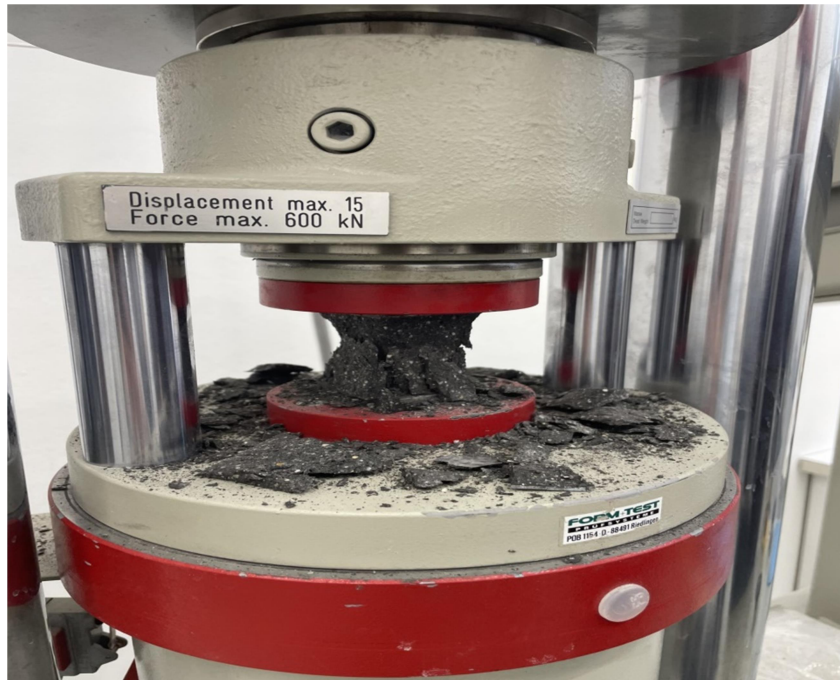
Slika 28. Ispitivanje tlačne čvrstoće UHPC betona
