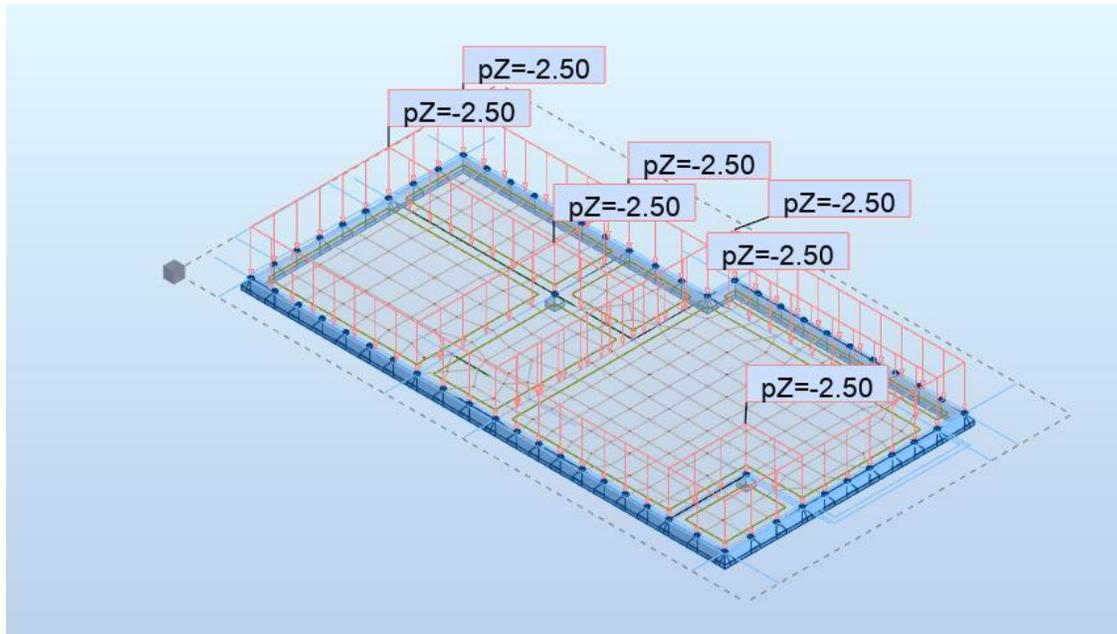
Slika 6.50. Dodatno stalno opterećenje ( $kN/m^2$  i  $kN/m$ )
