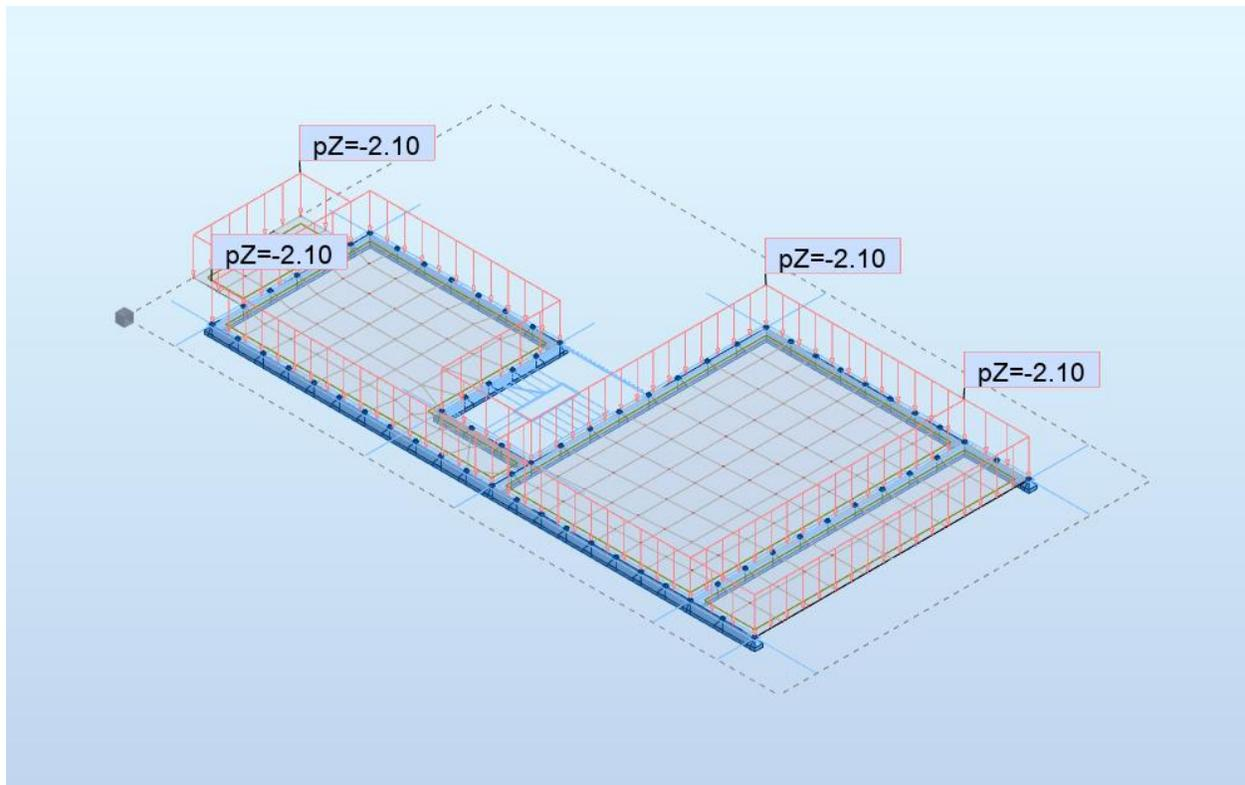
Slika 6.12. Dodatno stalno opterećenje ( $kN/m^2$ )
