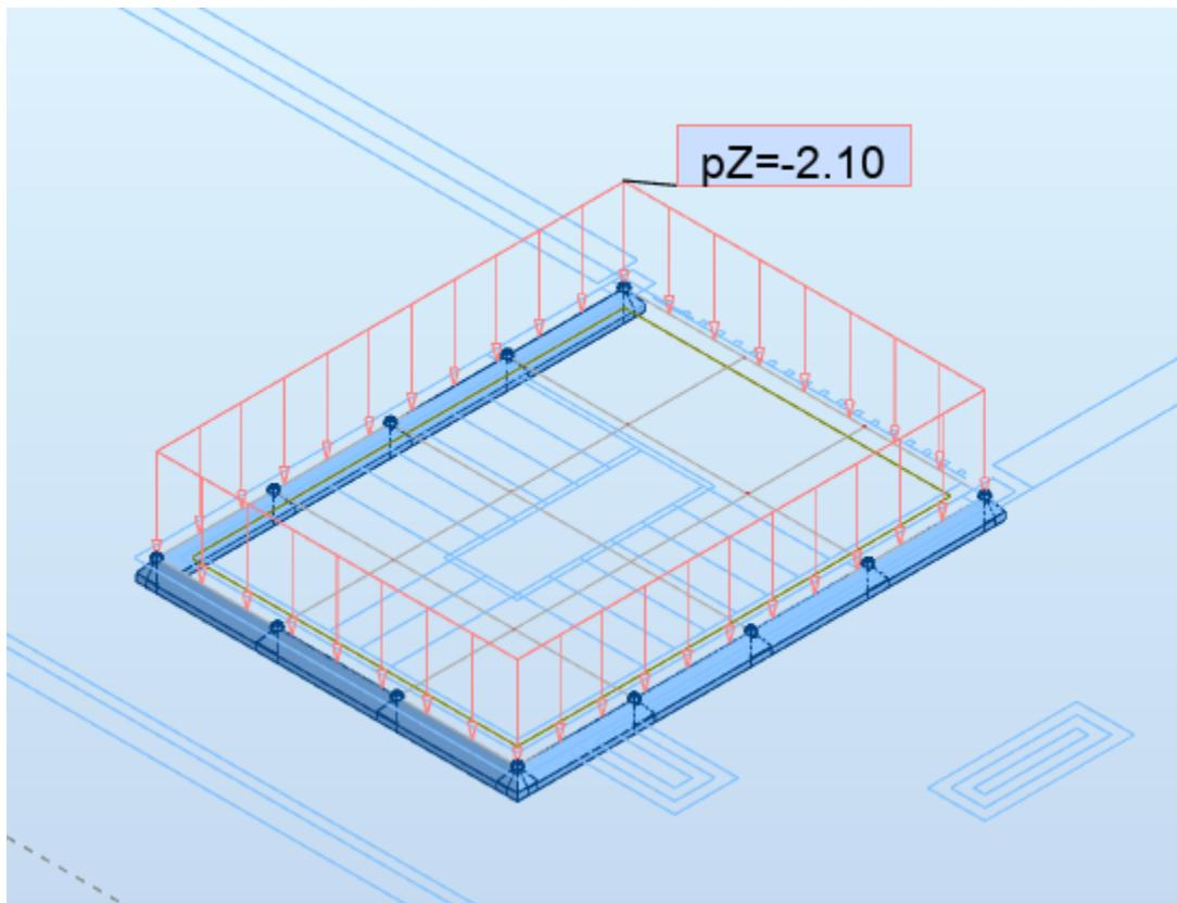
Slika 6.1. Dodatno stalno opterećenje ( $kN/m^2$ )
