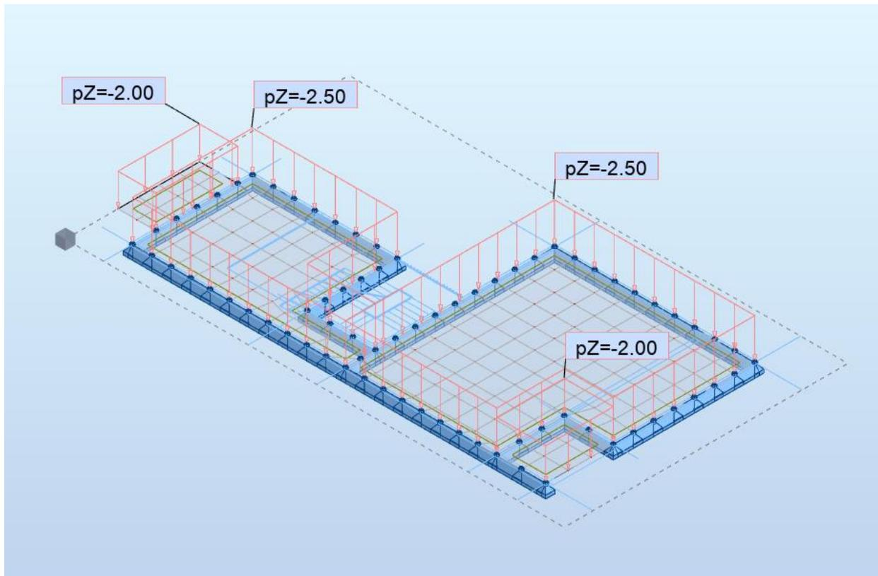
Slika 6.39. Dodatno stalno opterećenje ( $kN/m^2$ )
