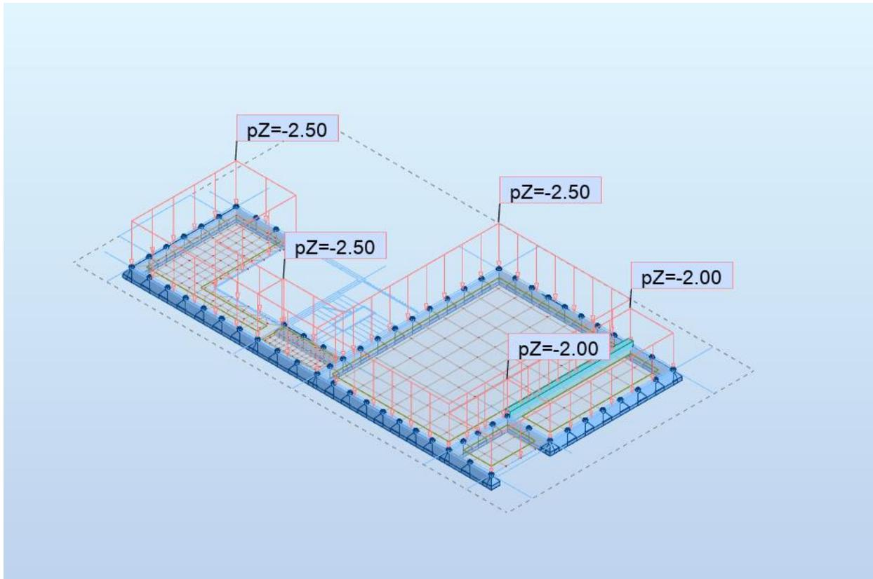
Slika 6.23. Dodatno stalno opterećenje ( $kN/m^2$  i  $kN/m$ )
