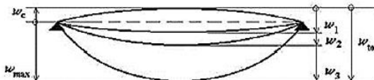
Slika 6.7 Prikaz progiba ploča
