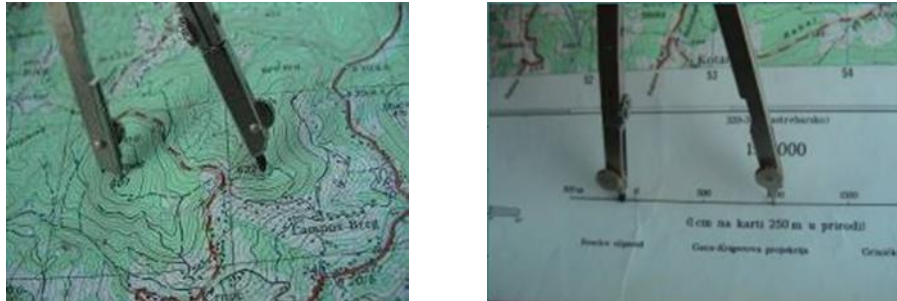
Slika 1.9. Mjerenje ravnih linija na karti
