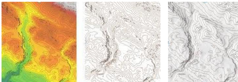
Slika 1.8. Prikazivanje visina na karti: hipsometrijskom skalom boja (lijevo), izohipsama (u sredini) sjenčenjem (desno)
