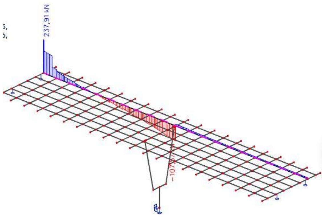
Slika 32. Pokretno – maksimalna poprečna sila pri upornjaku – poprečne sile ( $V_z$ ) u Kn
