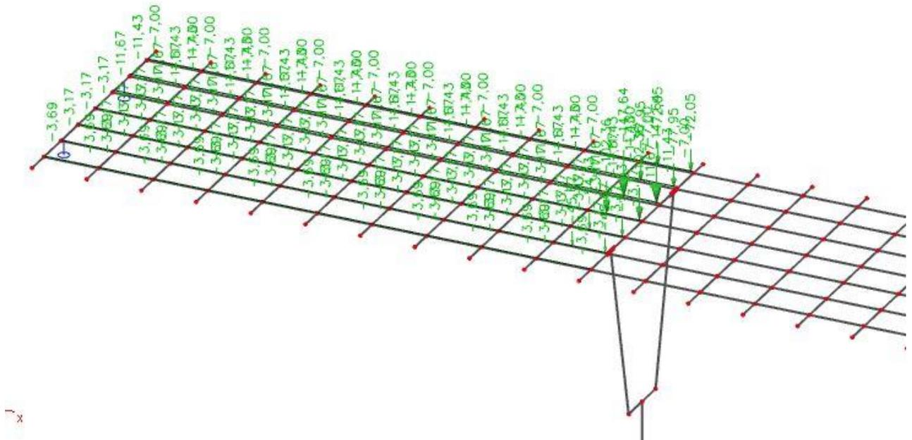
Slika 25. Pokretno opterećenje za maksimalnu poprečnu silu pri stupu
