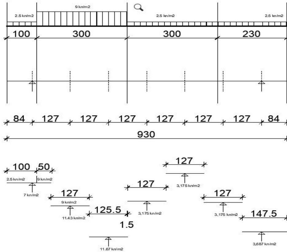
Slika 15. Analiza kontinuiranog opterećenja na uzdužnim nosačima
