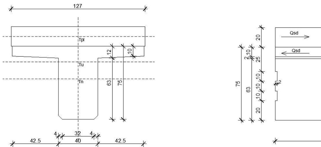
Slika 38. Poprečni presjek spregnutog T nosača
