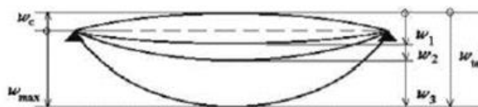
Slika 7.3 Prikaz progiba grede
