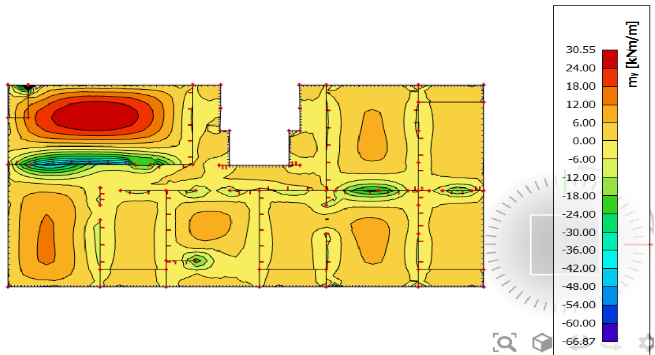
Slika 6.31. Prikaz momenata savijanja u polju M_y – GSN2
