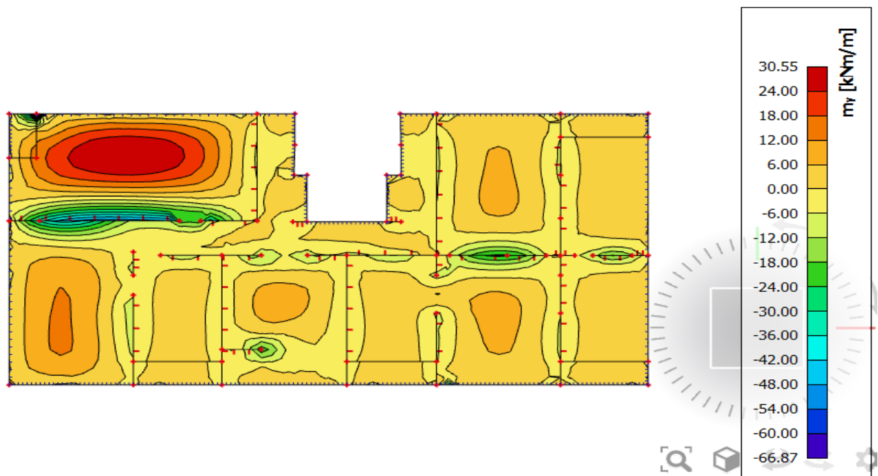
Slika 6.31. Prikaz momenata savijanja u polju M_y – GSN2
