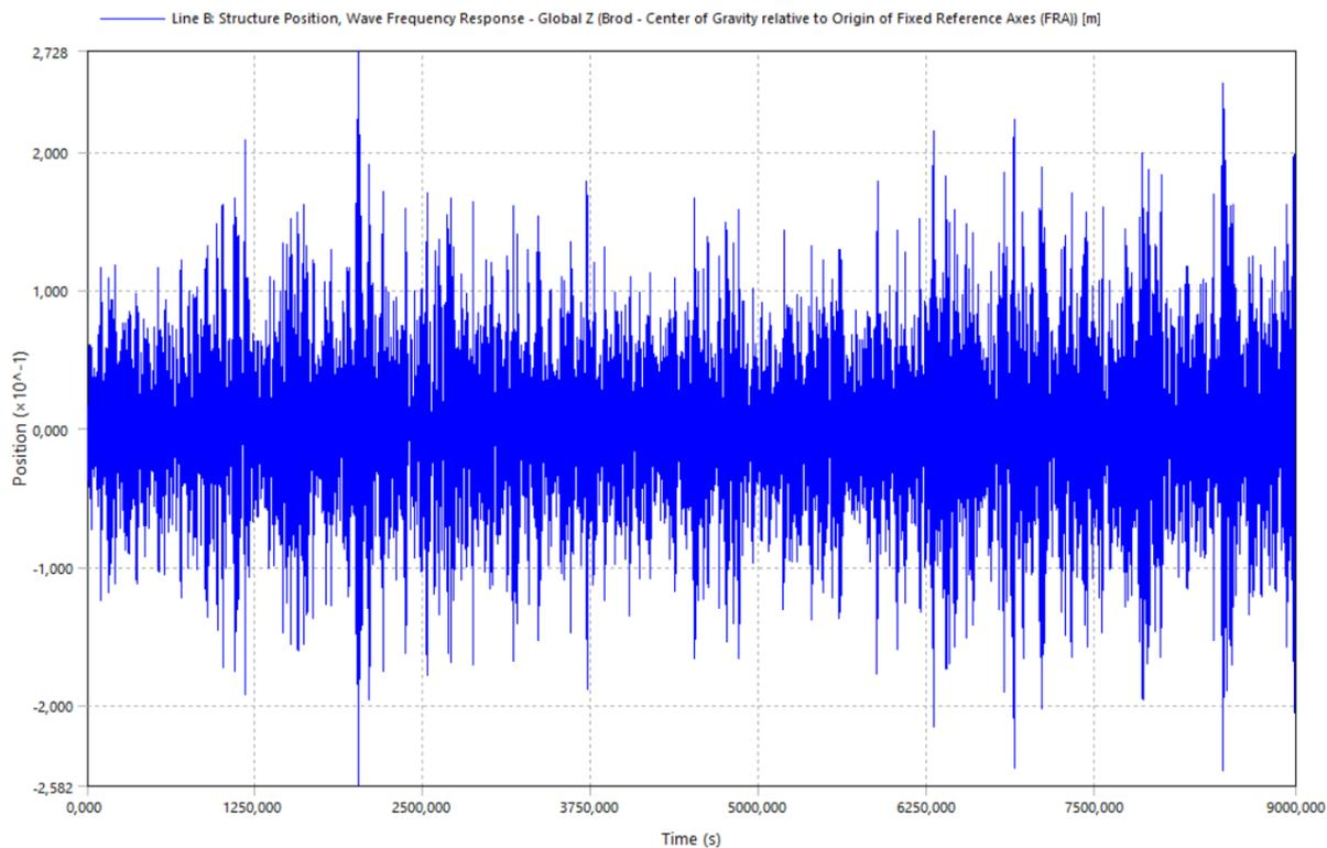
Slika 106 Pomak u z smjeru - wave frequency response
