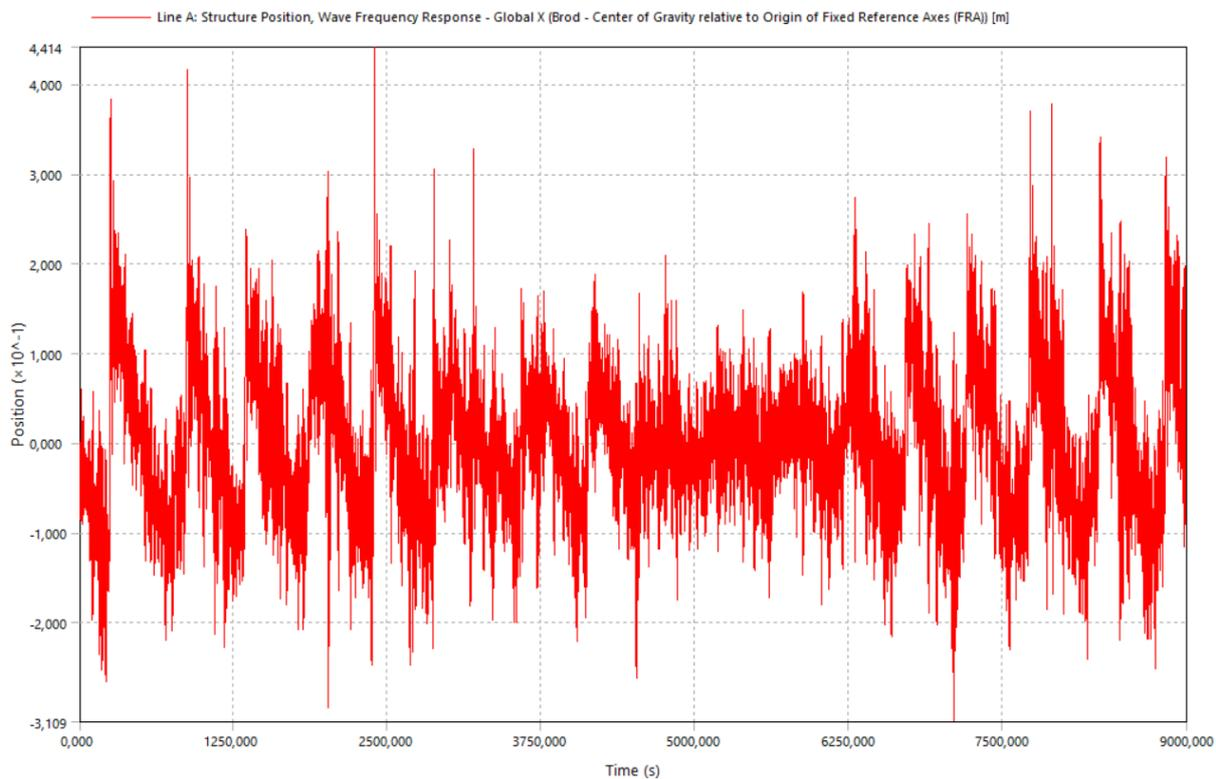
Slika 103 Pomak u x smjeru - wave frequency response
