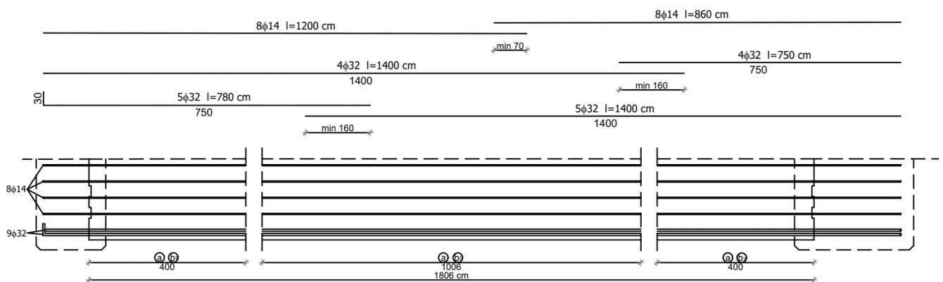
Slika 32. Prikaz armiranja uzdužnog nosača u polju
