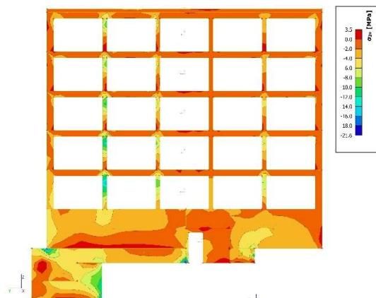
C1) Tlačna naprezanja u zidu za GSU-2:
