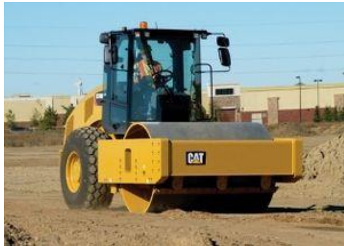
Slika 13. Valjak s glatkim čeličnim kotačem CP68B [6]
