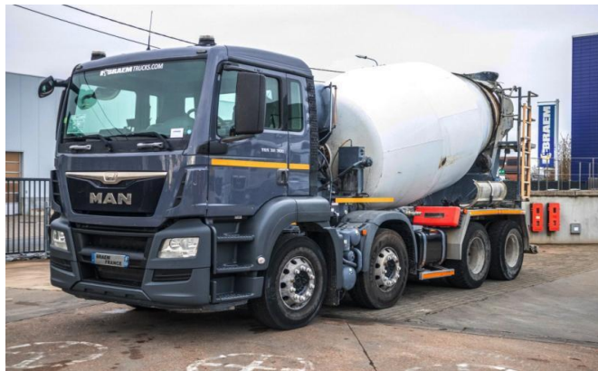
Slika 12. Automješalica MAN TGS 44.400 8x4 [5]
