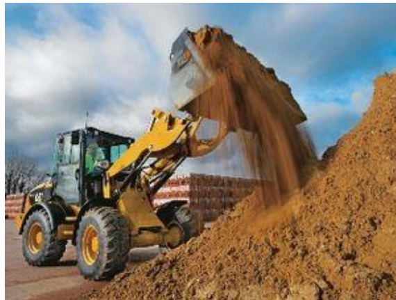
Slika 14. Utovarivač na kotačima CAT 938M [7]
