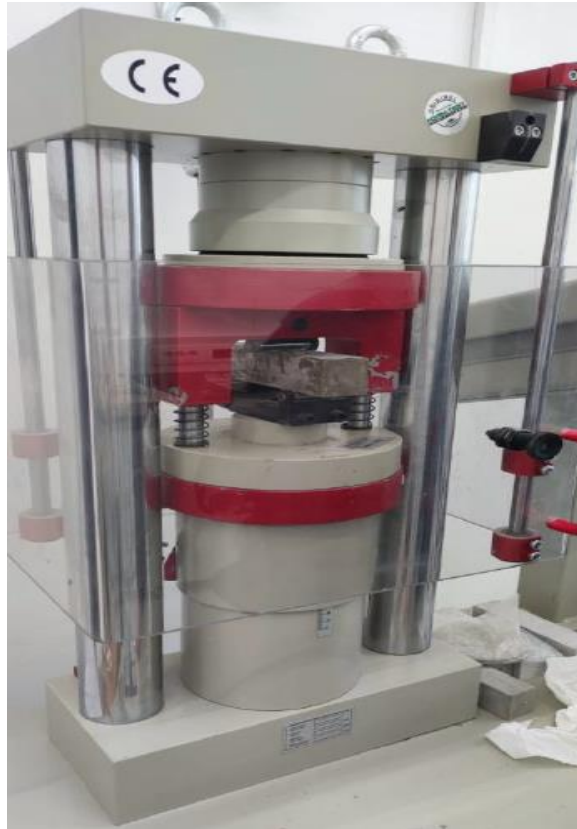
Slika 24. Ispitivanje savojne čvrstoće
