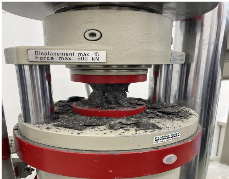
Slika 25. Ispitivanje tlačne čvrstoće
