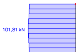
Slika 13.23. Maksimalna poprečna sila za izvanrednu kombinaciju
