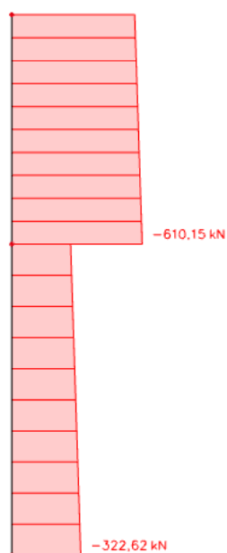
Slika 13.5. Pripadna uzdužna sila za kombinaciju GSN
