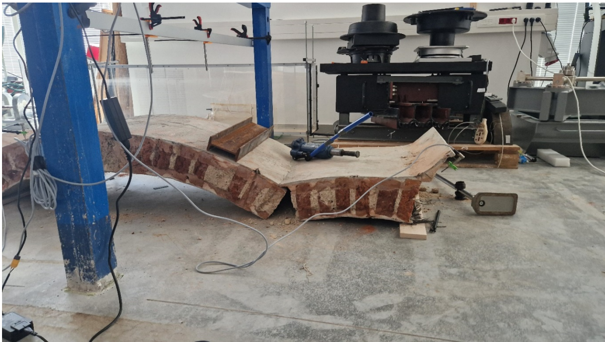
Fotografija 2.22 – Slom svoda
