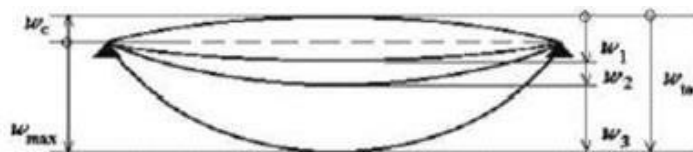
Slika 40 Prikaz progiba grede
