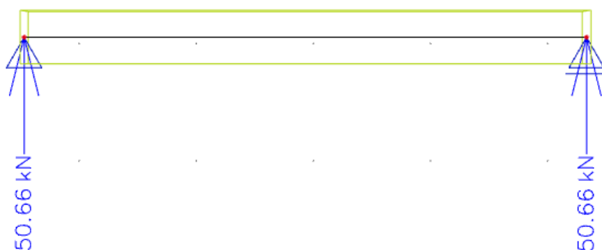
slika 11. reakcije na ležajevima uzrokovane opterećenjem q_1=21.11\text{kN/m} [4]
