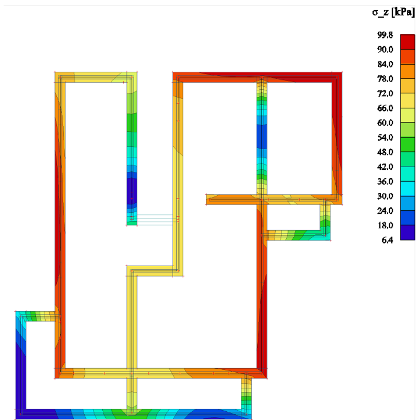
Slika 11.1.3 Linijske reakcije na mjestima oslanjanja zidova na temeljne trake (Kn/m) za kombinaciju GSN-1
