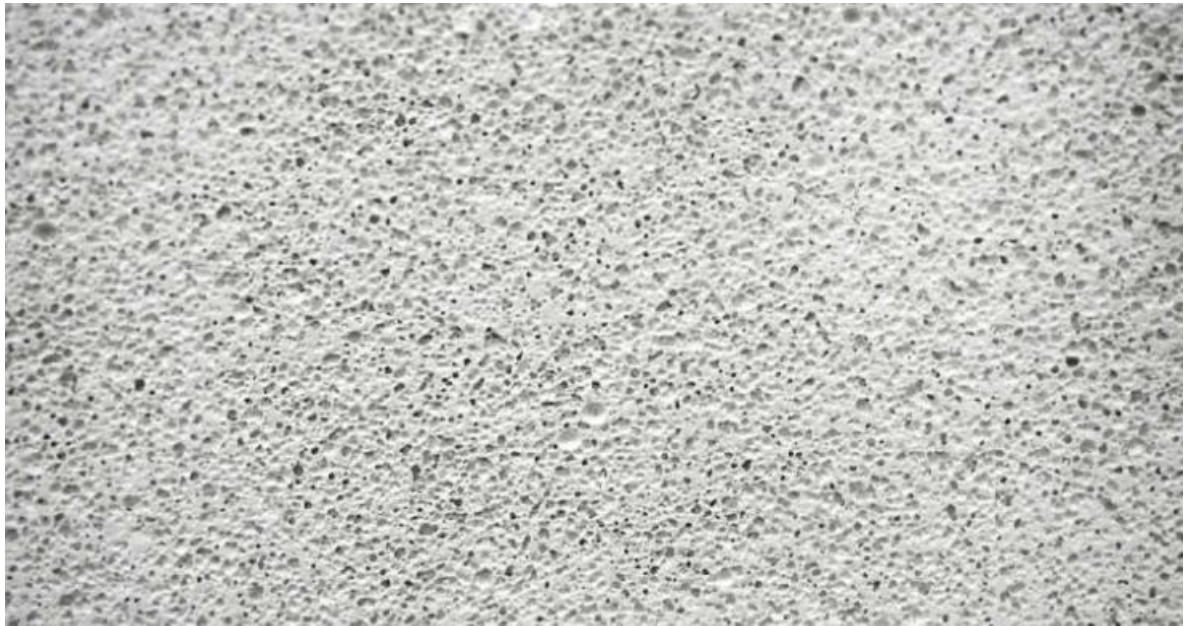
Slika 1. Struktura lakog betona [4]
