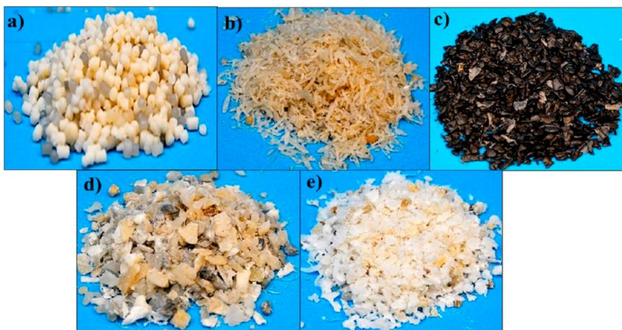
Slika 13. Tipovi recikliranog plastičnog agregata: a) zrna, b) vlakna, c) crne pahuljice, d) miješane pahuljice, e) bijele pahuljice [22]
