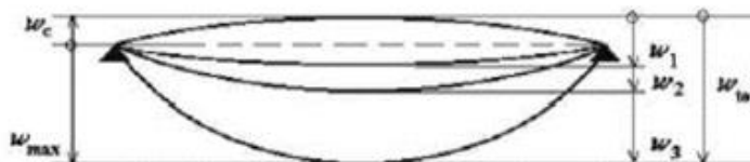
Slika 7.3 Prikaz progiba grede
