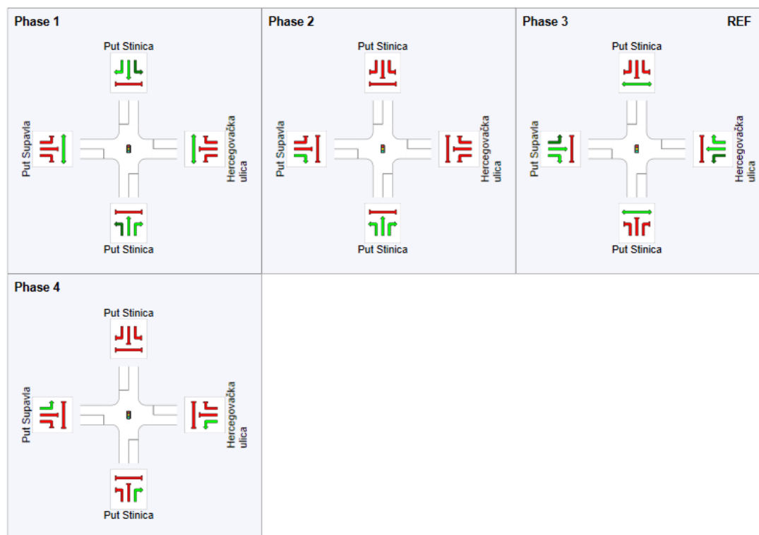
Slika 26. Faze svjetlosne signalizacije na raskrižju Put Stinica - Hercegovačka ulica - Put Supavla
