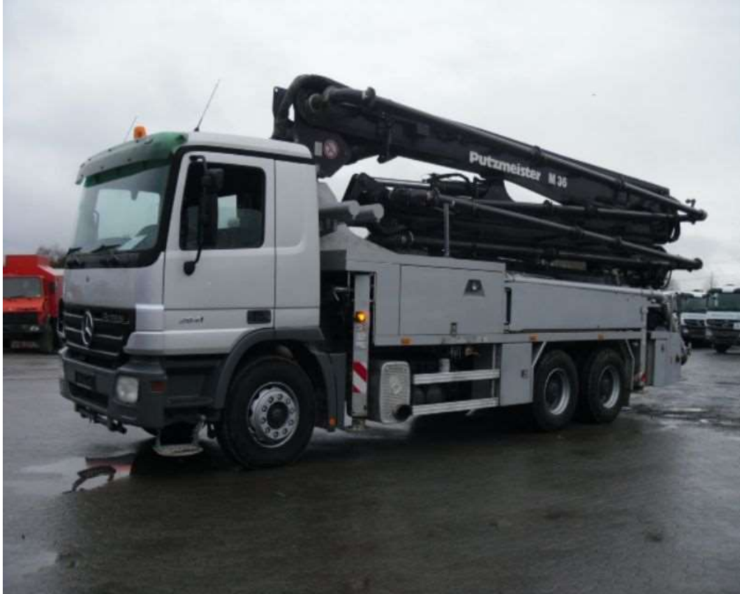
Slika 3.10 Pumpa za beton Mercedes-Benz 2641 Putzmeister 36m [4]
