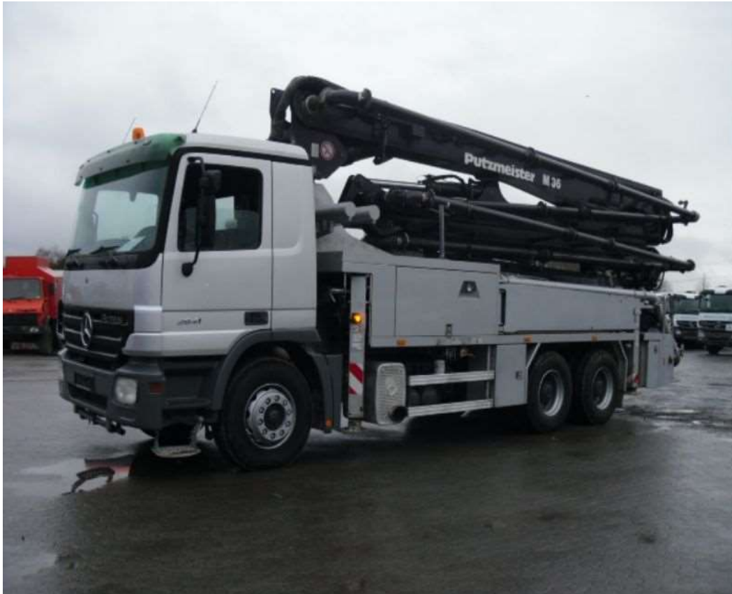
Slika 3.3 Pumpa za beton Mercedes-Benz 2641 Putzmeister 36m [4]
