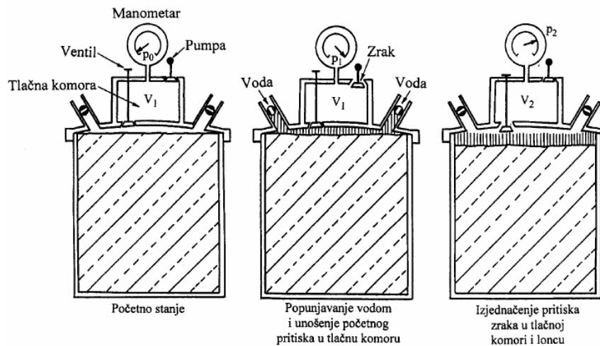
**Slika 3.5:** Uredaj za ispitivanje sadržaja pora u svježem betonu[8]
