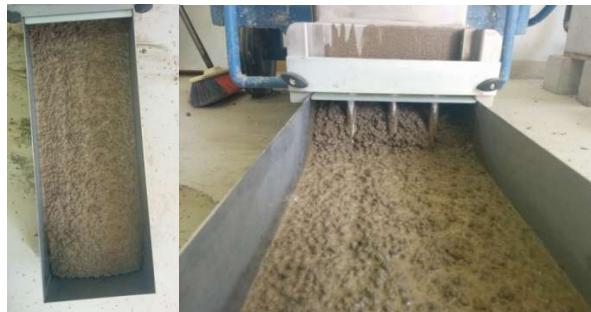
*Slika 7.24:Ispitivanje L-posudom – mješavina L2*
