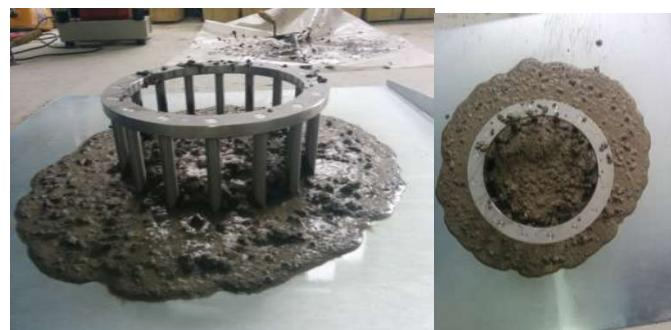
**Slika 7.17:**Ispitivanje J-prstenom - mješavina L3
