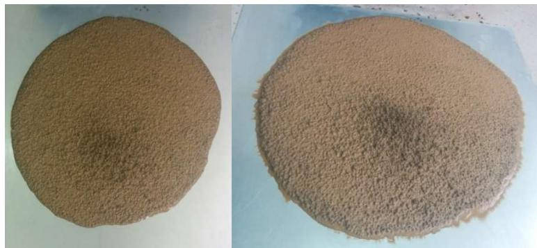
**Slika 7.3:** Rasprostiranje slijeganjem mješavine L1
