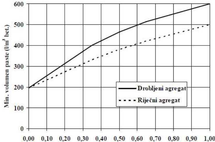
**Slika 2.4:** Određivanje minimalnog volumena paste
