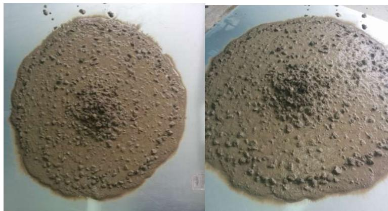
**Slika 7.5:** Rasprostiranje slijeganjem mješavine L3
