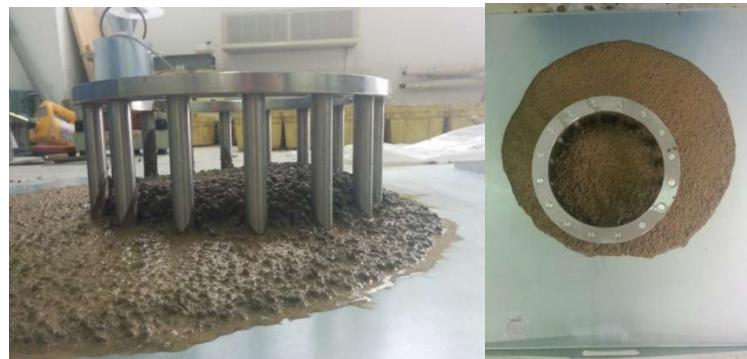
**Slika 7.15:**Ispitivanje J-prstenom - mješavina L1
