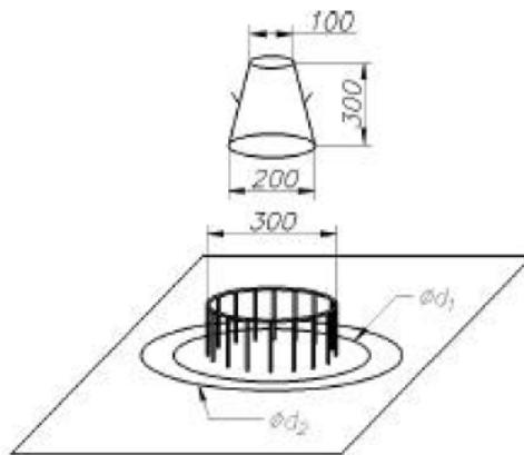
**Slika 3.3:** Dimenzije opreme za ispitivanje J prstenom[9]
