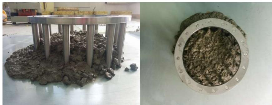
*Slika 7.18:Ispitivanje J-prstenom - mješavina L4*
