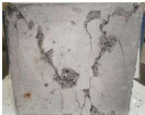
*Slika 5.9: Mješavina 1; vertikalni lom[17]*
