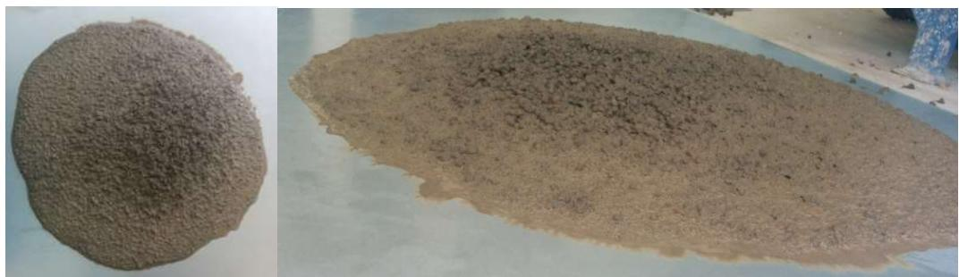
**Slika 7.4:** Rasprostiranje slijeganjem mješavine L2
