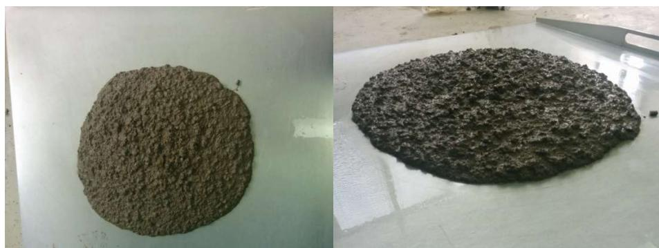
**Slika 7.7:** Rasprostiranje slijeganjem mješavine L5
