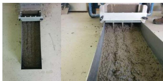
**Slika 7.28:**Ispitivanje L-posudom – mješavina L6
