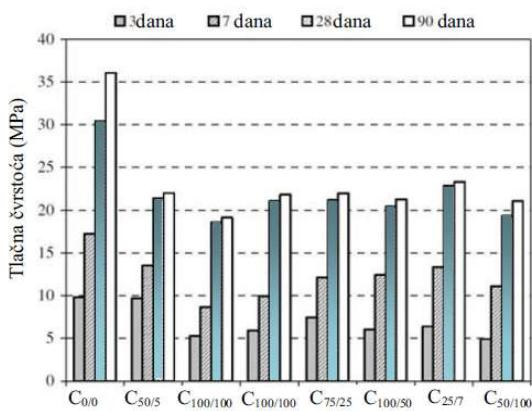
Slika 4.3: Tlačne čvrstoće betona[11]
