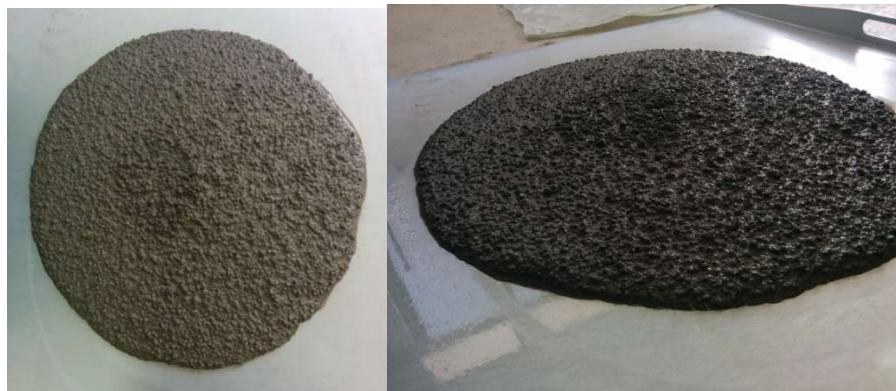
*Slika 7.8: Rasprostiranje slijeganjem mješavine L6*
