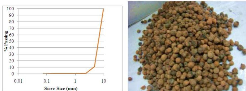
*Slika 5.6: a) granulometrijski sastav primljenog agregata (lijevo); b) prikaz laganog agregata od letećeg pepela (desno)[17]*
