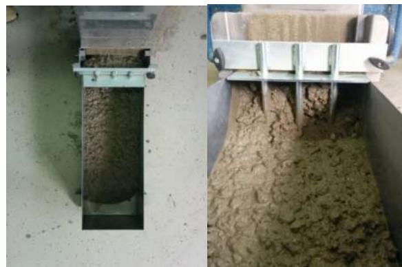
**Slika 7.26:**Ispitivanje L-posudom – mješavina L4
