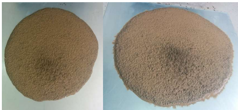
Slika 7.3: Rasprostiranje slijeganjem mješavine L1
