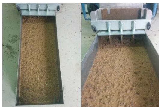
**Slika 7.23:** Ispitivanje L-posudom – mješavina L1
