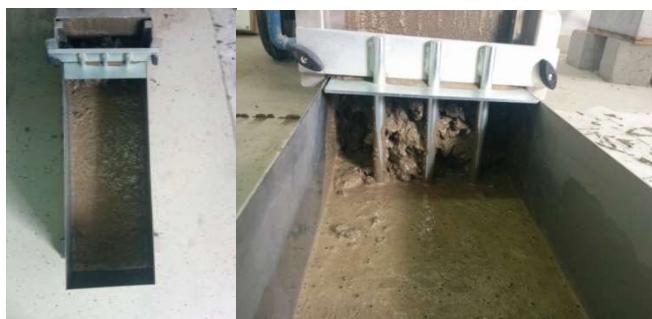
*Slika 7.25:Ispitivanje L-posudom – mješavina L3*
