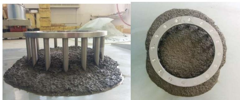
*Slika 7.20:Ispitivanje J-prstenom - mješavina L6*
