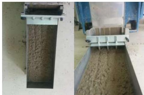
**Slika 7.27:**Ispitivanje L-posudom – mješavina L5
