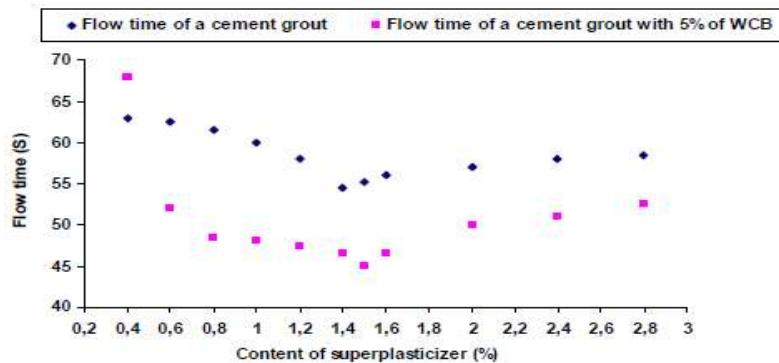
**Slika 5.2:** Vrijeme tečenja cementne paste s dodatkom 5 % WCB[13]
