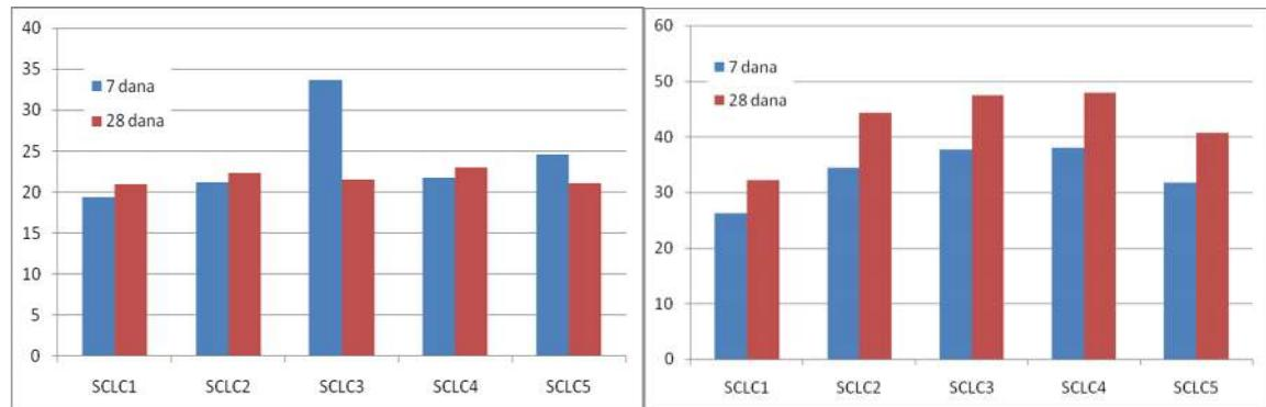
**Slika 5.16:** Dinamički modul elastičnosti (slika lijevo) i tlačne čvrstoće (slika desno) uzorka različitih starosti[18]
