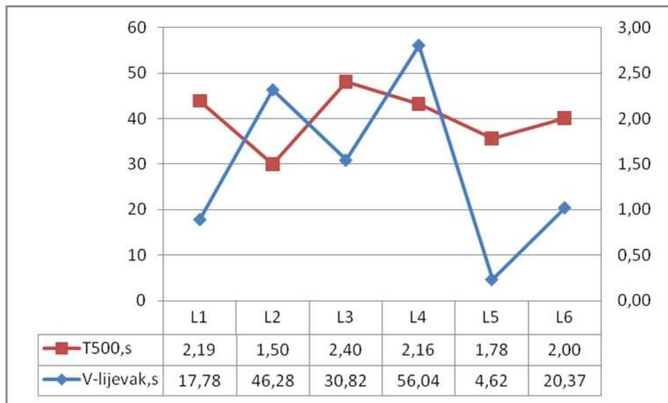
**Slika 7.12:**Grafički prikaz rezultata ispitivanja V-ljevkom i vremena  $t_{500}$
