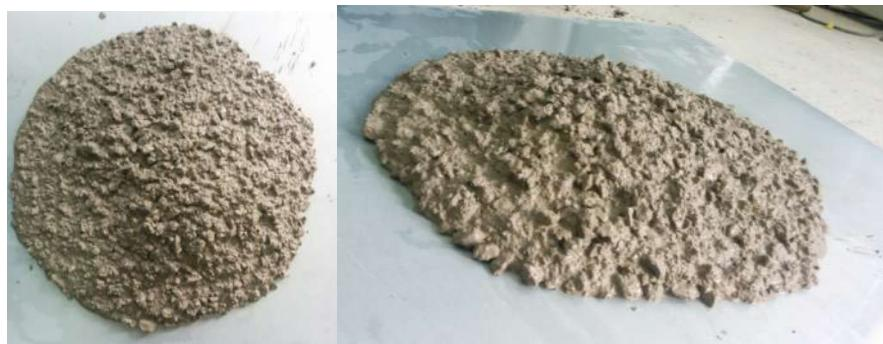
**Slika 7.6:** Rasprostiranje slijeganjem mješavine L4
