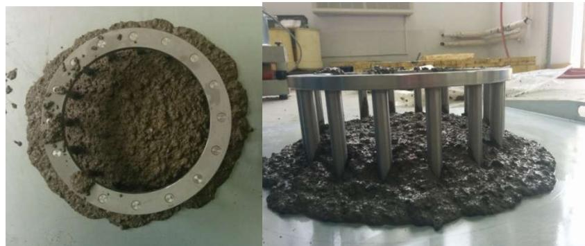
*Slika 7.19:Ispitivanje J-prstenom - mješavina L5*
