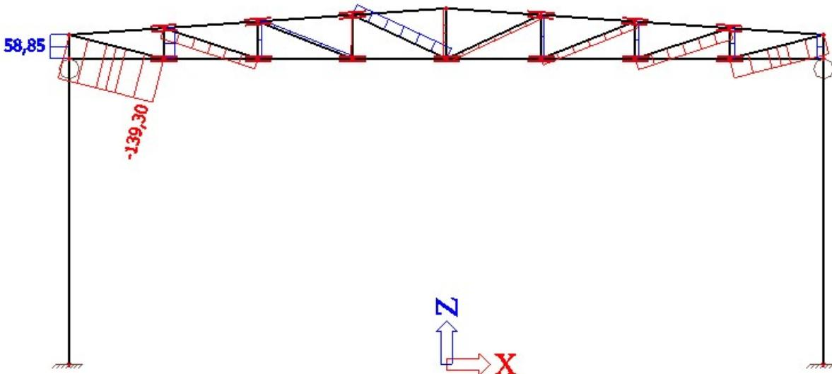
Slika 20. Maksimalna tlačna uzdužna sila u ispuni rešetke
