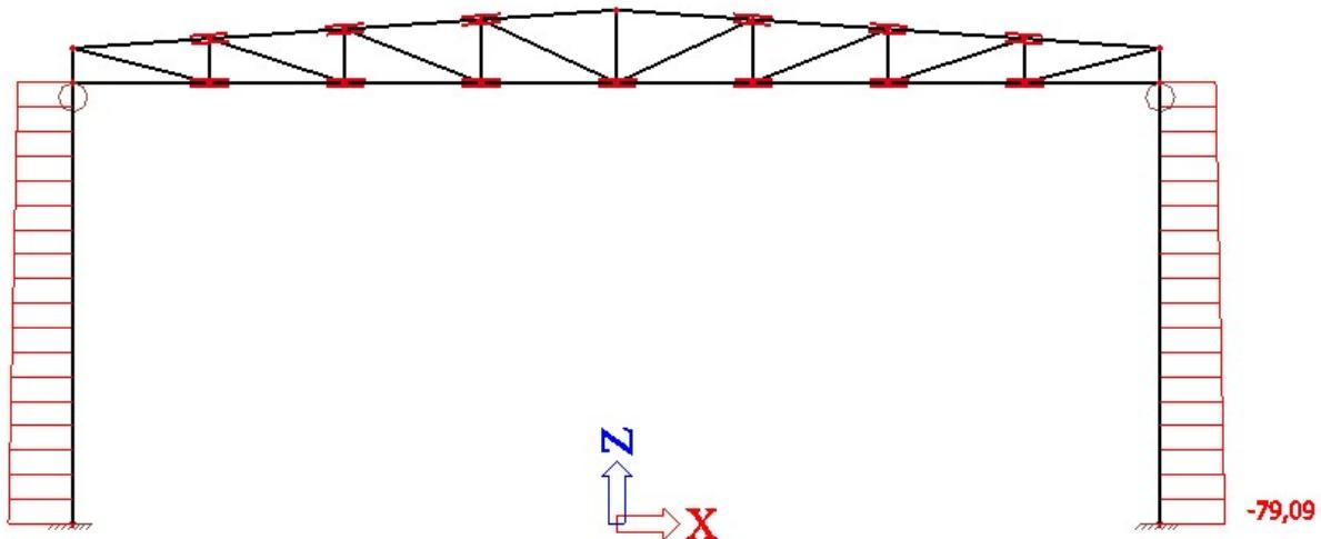
Slika 15. Maksimalna tlačna uzdužna sila u stupu
