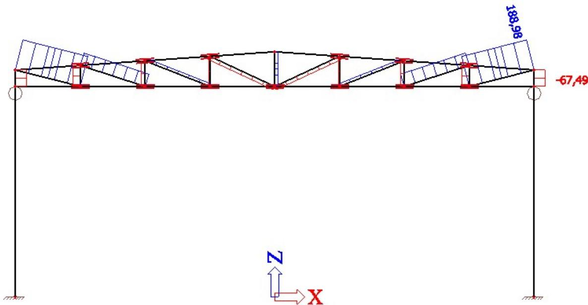
Slika 19. Maksimalna vlačna uzdužna sila u ispuni rešetke
