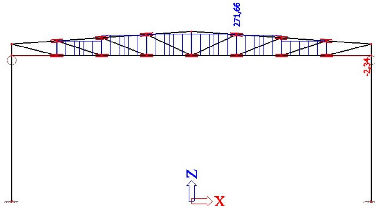
Slika 17. Anvelopa uzdužnih sila u donjem pojusu rešetke
