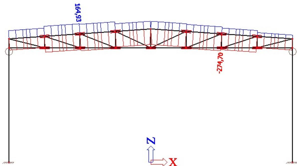
Slika 18. Anvelopa uzdužnih sila u gornjem pojusu rešetke
