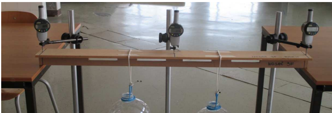
Slika 8.11. Postavljene mikroure na predviđenim mjernim mjestima
