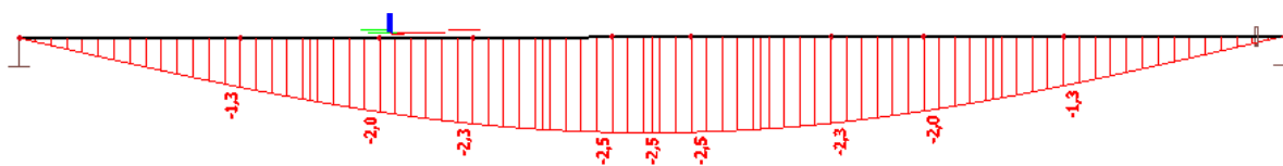
Slika 4.5. Progibi pri opterećenju silom od 14,9 kN
