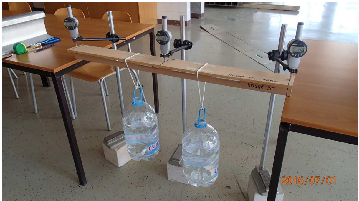
Slika 8.9. Mjerna mjesta-krajevi nosača i sredina raspona; opterećenje-u trećinama raspona
