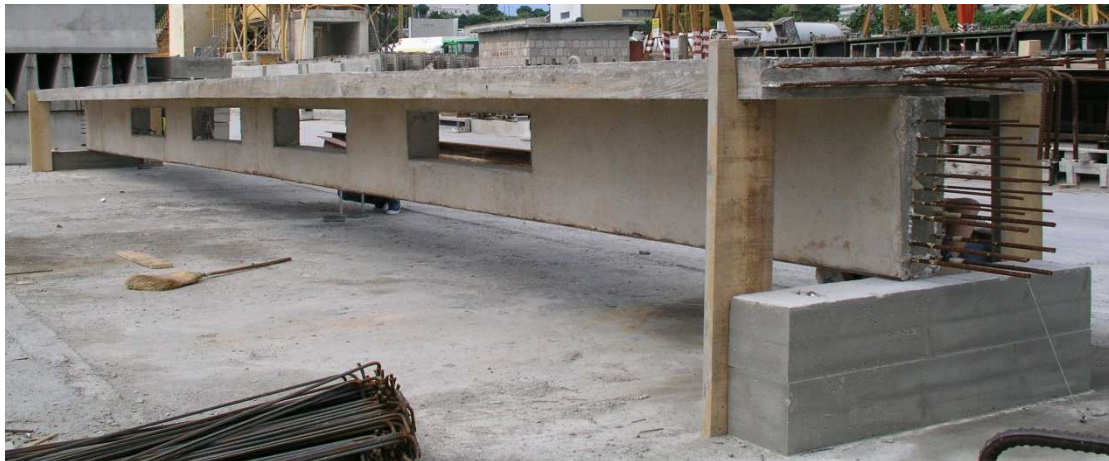
Slika 3.1. Nosač montiran na oslonce na mjestu ispitivanja
