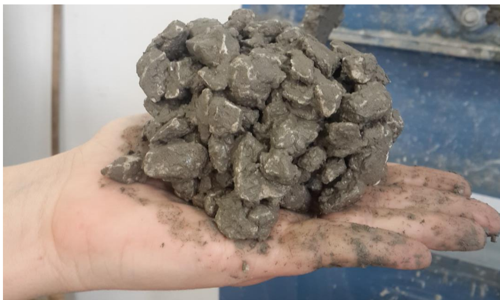
Slika 4.15 Ispitivanje konzistencije metodom oblikovanja kuglice
