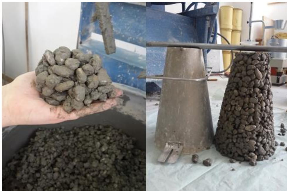
Slika 5.2 Ispitivanje konzistencije mješavine B 2
