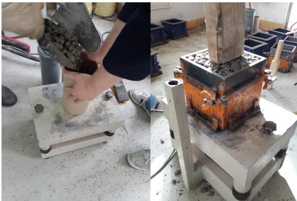
Slika 4.11 Ugrađivanje uzoraka vibriranjem na vibrostolu
