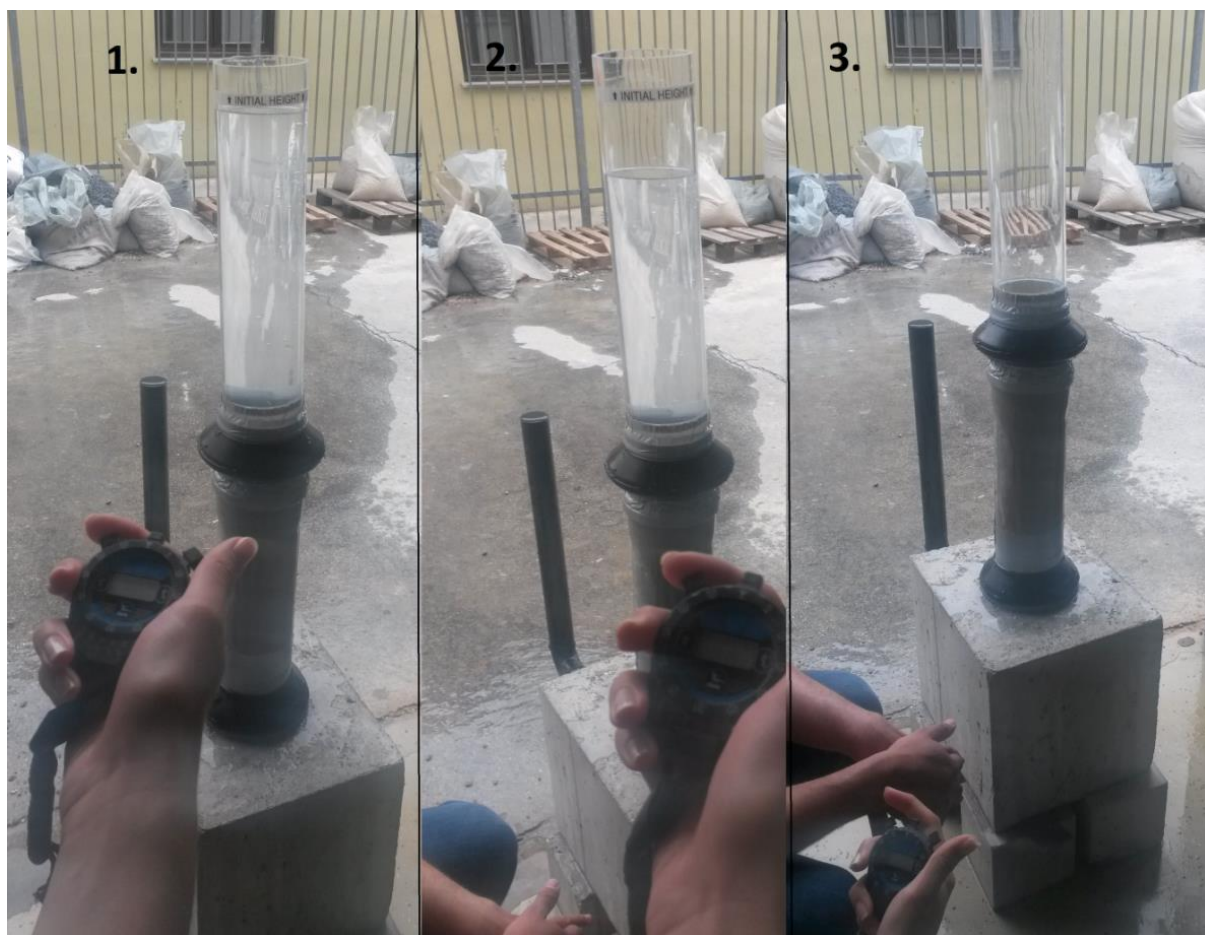
Slika 4.18 Mjerenje koeficijenta propusnosti metodom padajuće razine stupca vode [14]
