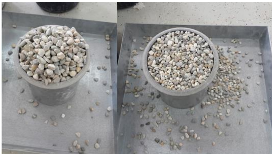
Slika 4.7 Mjerenje nasipne gustoće agregata
