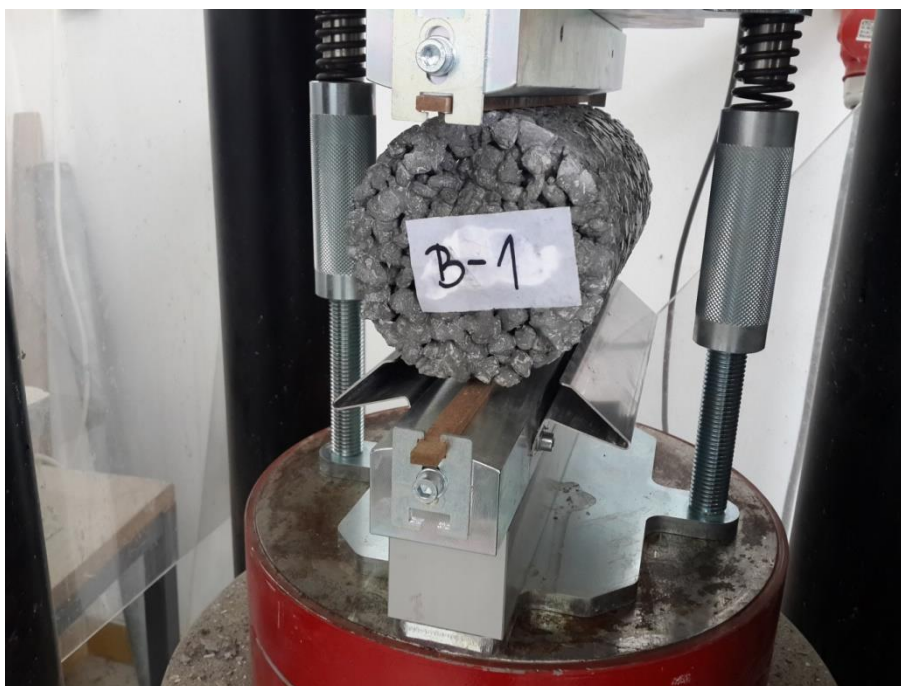
Slika 4.20 Opterećenje uzorka poprečno po izvodnici
