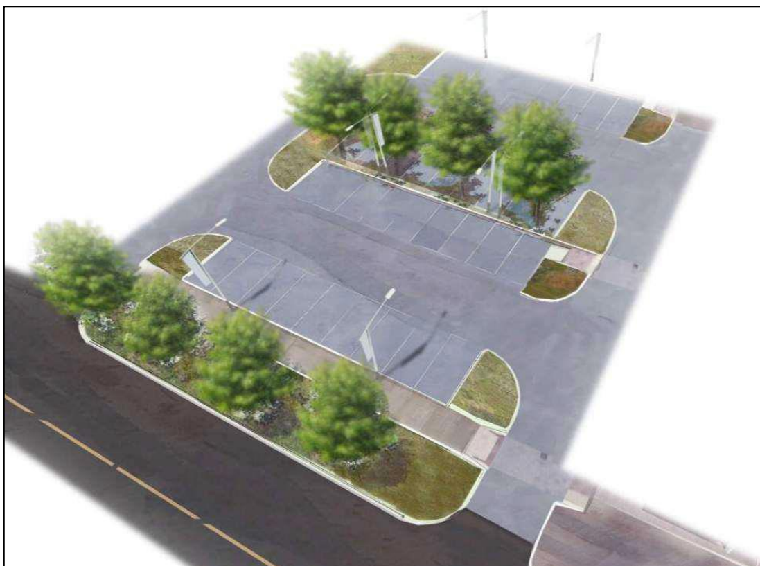
Slika 2.4 Moderno parkiralište od poroznog betona [10]
