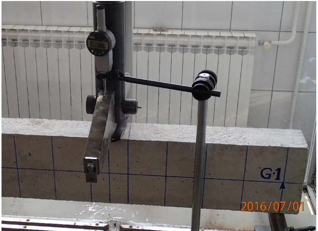
Fotografija 4.7 Slika postavljanja i nuliranja mikroure
