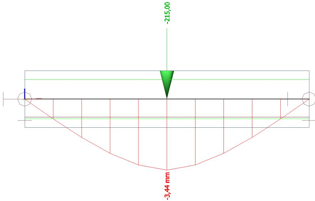
**Crtež 3.9.**Prikaz progiba grede G2 ojačane karbonskom trakom (duljine 96 cm) pri opterećenju iznosa 220 Kn
