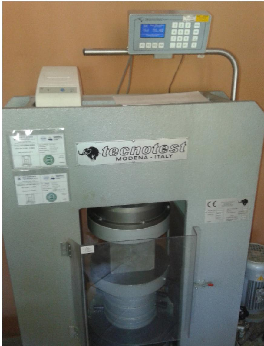
**Fotografija 2.7.** Uzorci U1 prilikom ispitivanja tlačne čvrstoće
