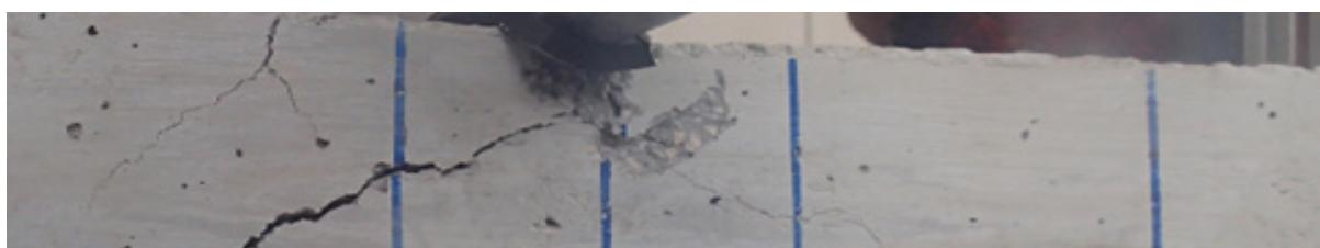
Fotografija 4.17. Grede G2 tijekom nanošenja sile, prikaz lokalnog oštećenja
