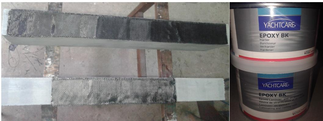
**Fotografija 2.9.** Greda G2 i G3 ojačana karbonskom trakom (pogled na preokrenutu gredu prilikom lijepljenja) i kantice s komponentama epoxy smole
