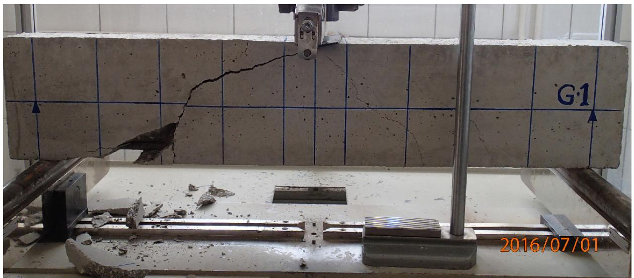
Fotografija 4.11. Slom i kraj ispitivanja grede G1
