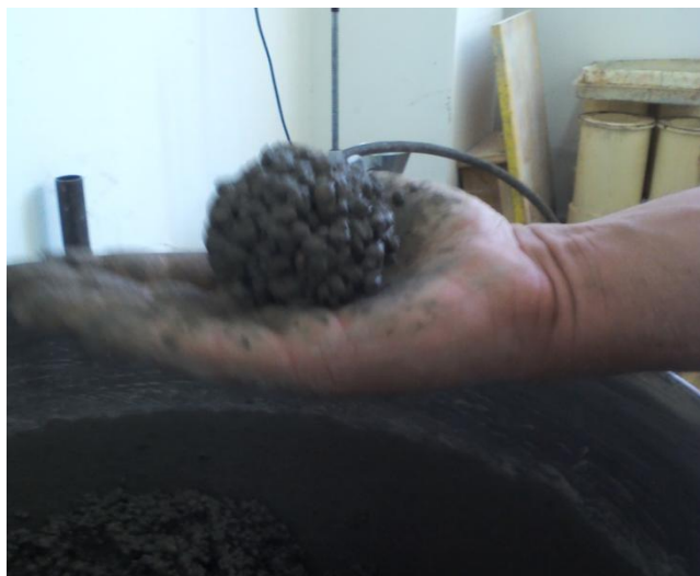
Slika 4.19. Ispitivanje konzistencije mješavine K 5
