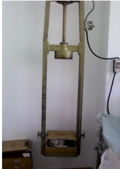
Slika 4.2. Strojno prosijavanje Liapora
