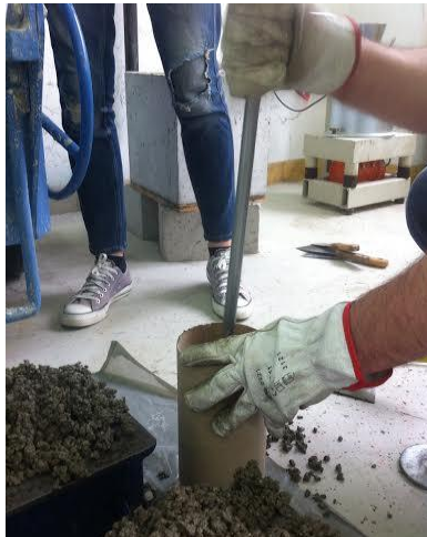
Slika 4.8. Ugrađivanje uzoraka u kalupe
