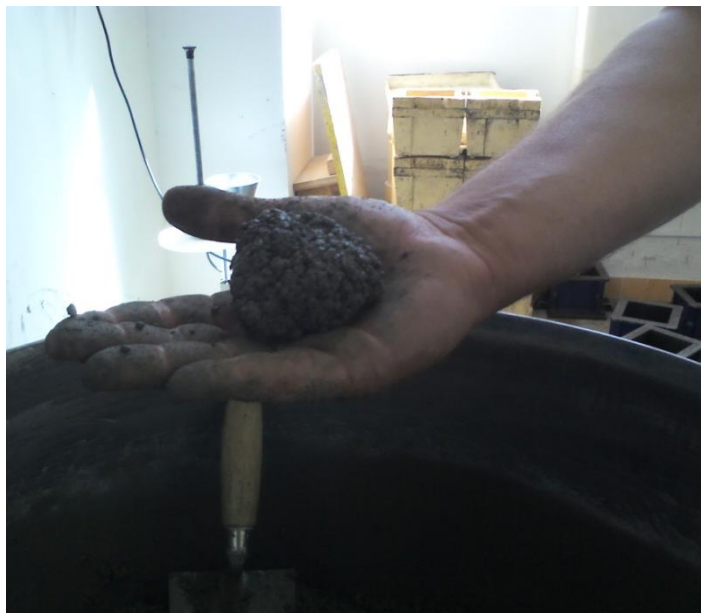
Slika 4.20. Ispitivanje konzistencije mješavine K 6
