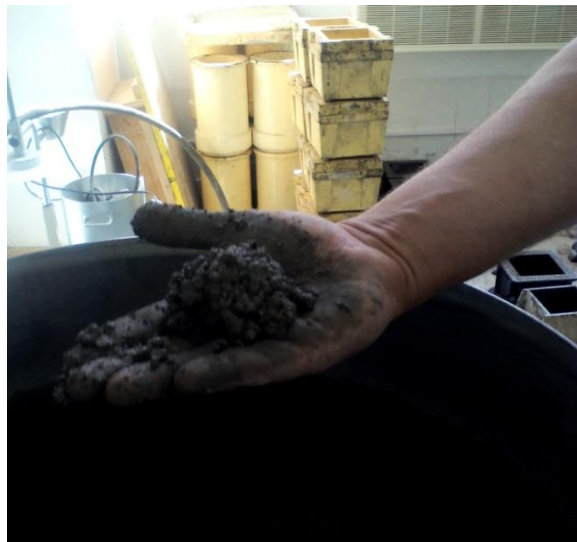
Slika 4.17. Ispitivanje konzistencije mješavine K_3
