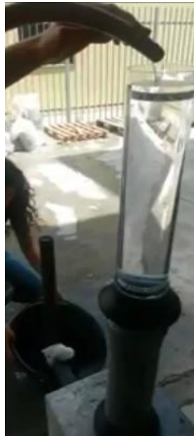
Slika 4.12. Ispitivanje propusnosti metodom stalne razine stupca vode
