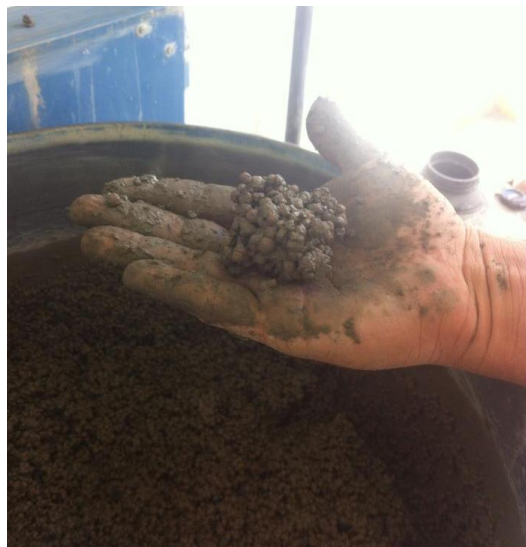
Slika 4.15. Ispitivanje konzistencije mješavine K_1
