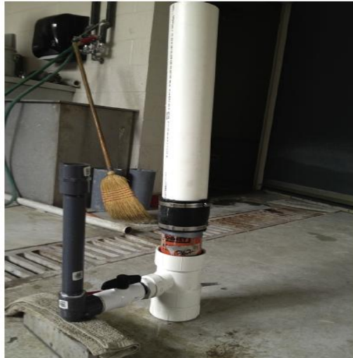
Slika 3.12. Uređaj za ispitivanje propusnosti sa stalnom razinom stupca tekućine[16]
