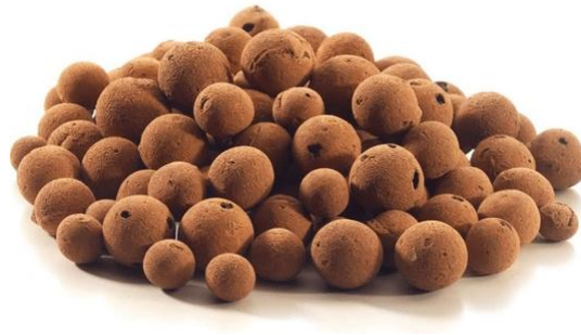
Slika 2.8. Lagani agregat od ekspanzirane gline[10]
