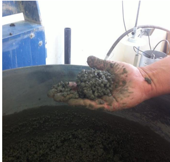
Slika 4.16. Ispitivanje konzistencije mješavine K_2
