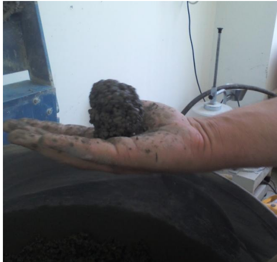
Slika 4.18. Ispitivanje konzistencije mješavine K 4
