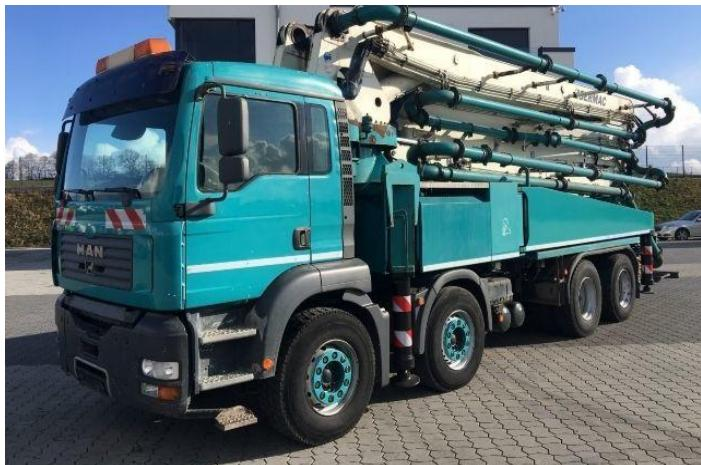
Slika 14. Pumpa za beton MAN JXM 4215 TGA 41.390 [5]
