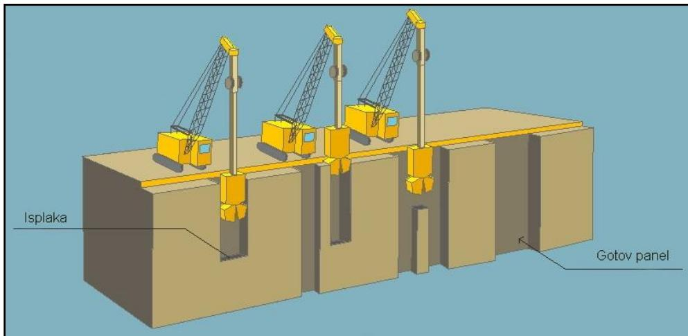
Slika 10. Iskop AB dijafragme mehaničkim grabilicama [6]
