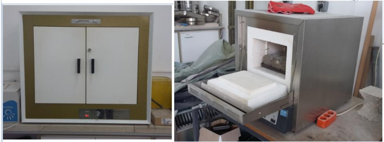
Slika 6.1 Lijevo:sušionik, desno:peć [slika zabilježena tijekom ispitivanja]
