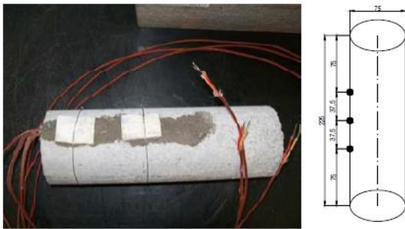
Slika 4.16 Položaj mjernih točaka na uzorku za određivanje tlačne čvrstoće i modula elastičnosti [7]
