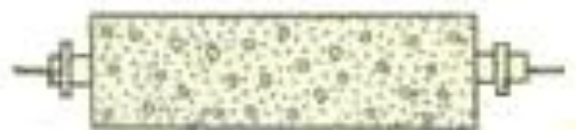
Slika 6.6 Skica mjerenja brzine ultrazvučnog vala
