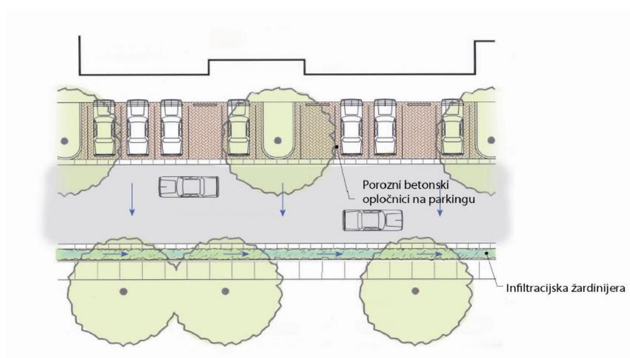
*Slika 31. Prijedlog izvedbe integralne odvodnje na trgovima – parking površinama*
