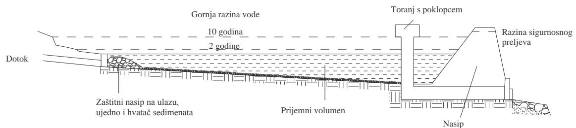
Slika 41. Tlocrt i presjek retencije
