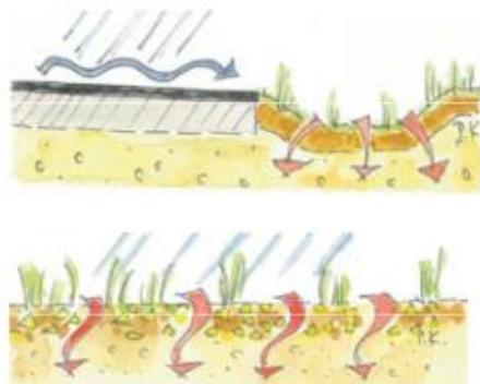
Asfaltirane površine sa kanalima koji vode oborinske vode do udubine ispunjene humusnim slojem radi infiltracije.
