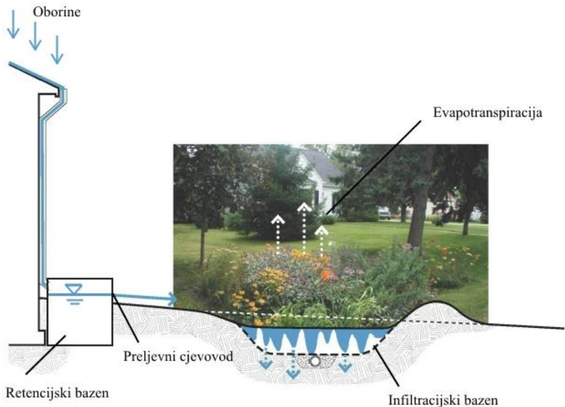
Slika 24. Prikaz odvodnje oborinskih voda sa krovišta kuća
