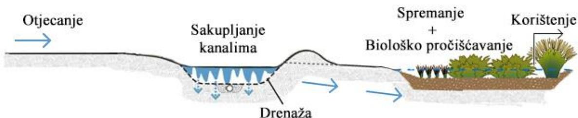
*Slika 37. Shema uređaja za sakupljanje – spremanje + pročišćavanje*
