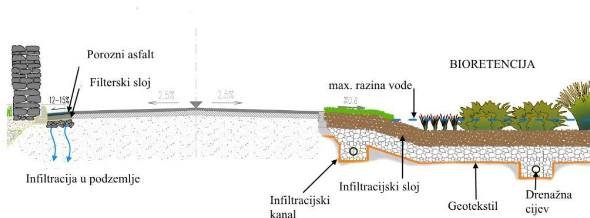
Slika 35. Prijedlog izvedbe integralne odvodnje na glavnim ulicama
