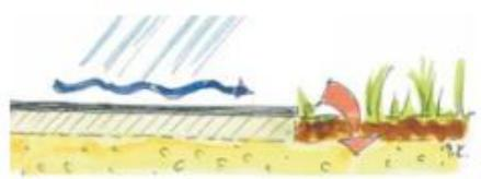
Površinsko odvođenje oborinskih voda preko čvrste podlage ili putem kanala koji vode do najbliže zelene površine radi infiltracije.
