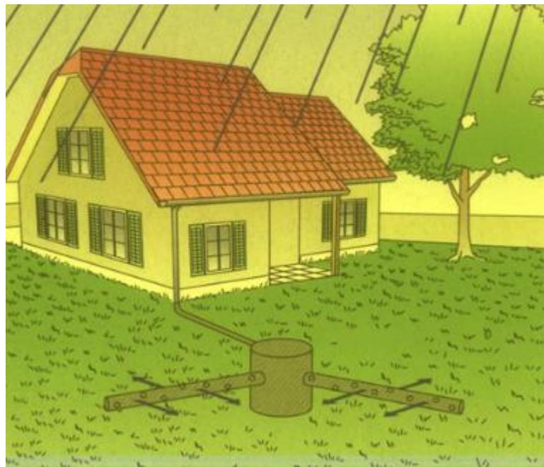
*Slika 28. Odvod oborinskih voda okućnice drenažnim cijevima*
