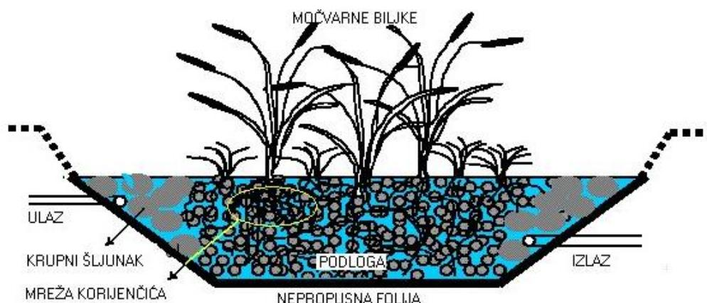
Slika 20. - Klasični pod površinski biljni uređaj
