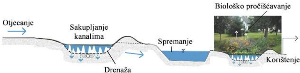
*Slika 38. Shema uređaja za sakupljanje – spremanje – pročišćavanje*
