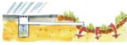
Asfaltirane površine sa šahtovima koji vode oborinske vode do udoline ispunjene humusnim slojem radi infiltracije.
