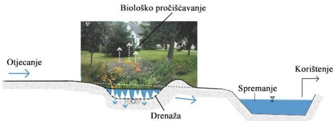
*Slika 36. Shema uređaja za pročišćavanje – sakupljanje – spremanje*
