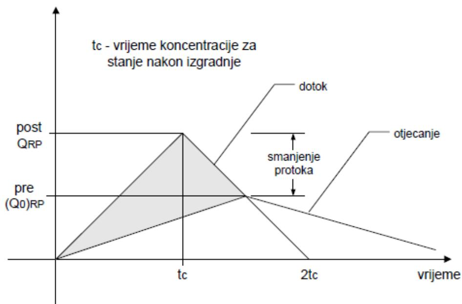
Slika 18. Trokutasti hidrogram dotoka za određivanje retencijskog volumena
