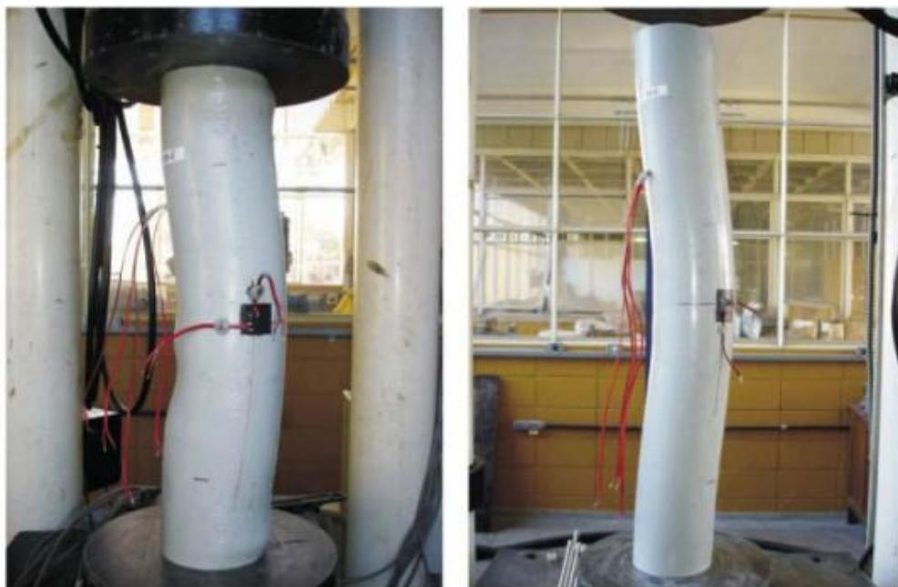
Slika 1.1. Izvijeni štap uslijed tlačne sile [4]
