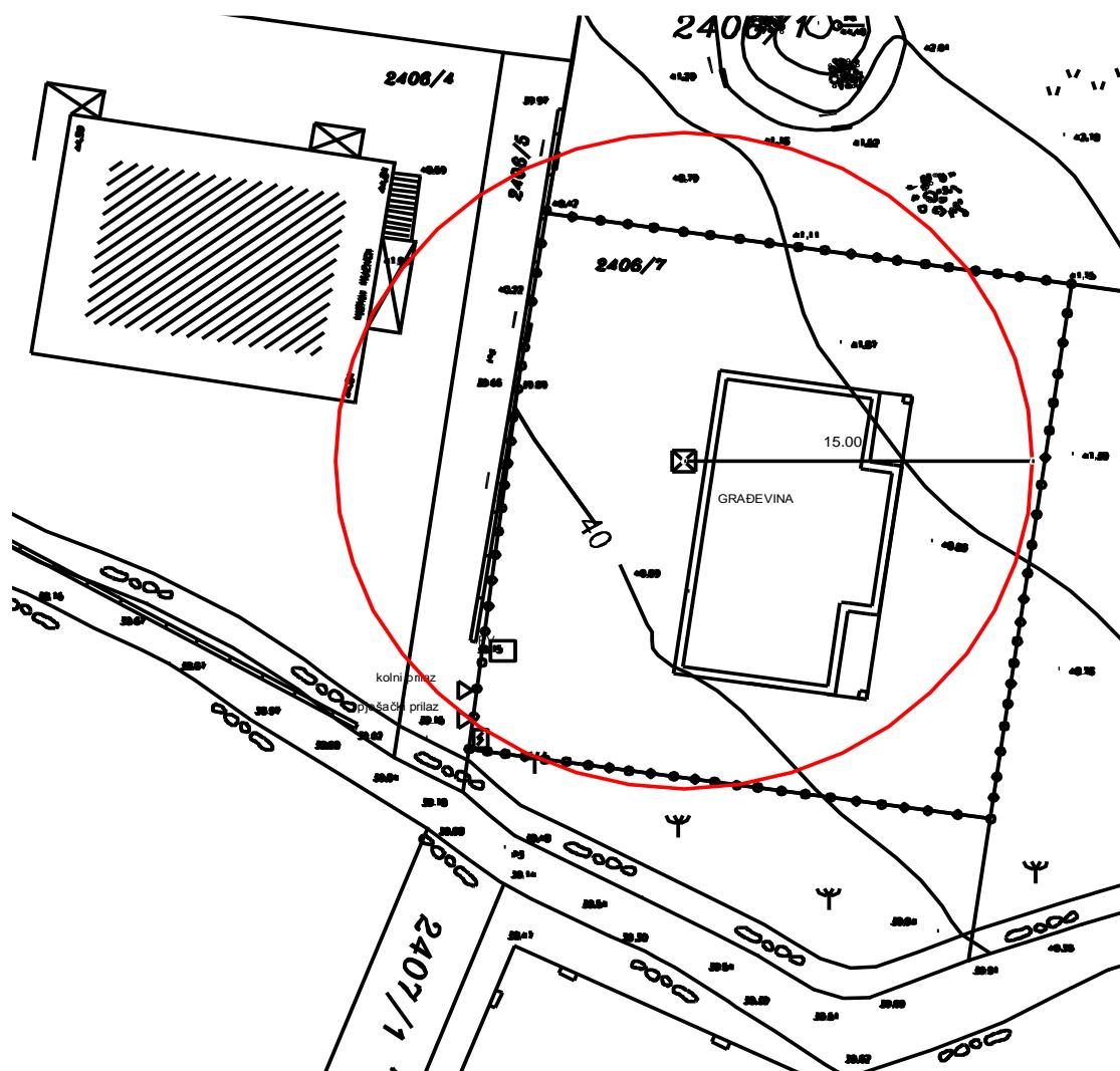
**Slika 5.** Prikaz tlocrte pokrivenosti građevine kranom
