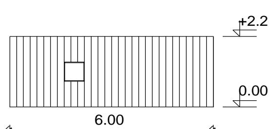
**Slika 6.** Dimenzije kontejnera na gradilištu
