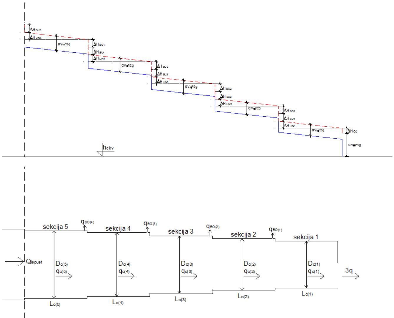
Slika 5.9. uzdužni presjek difuzora s prikazom energetske linije
