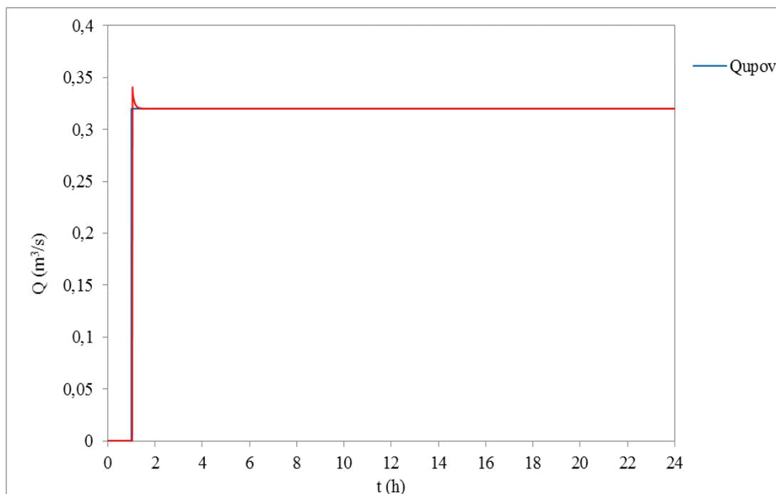
Slika 5.18. Protok ispod zapornice uslijed naglog dotoka
