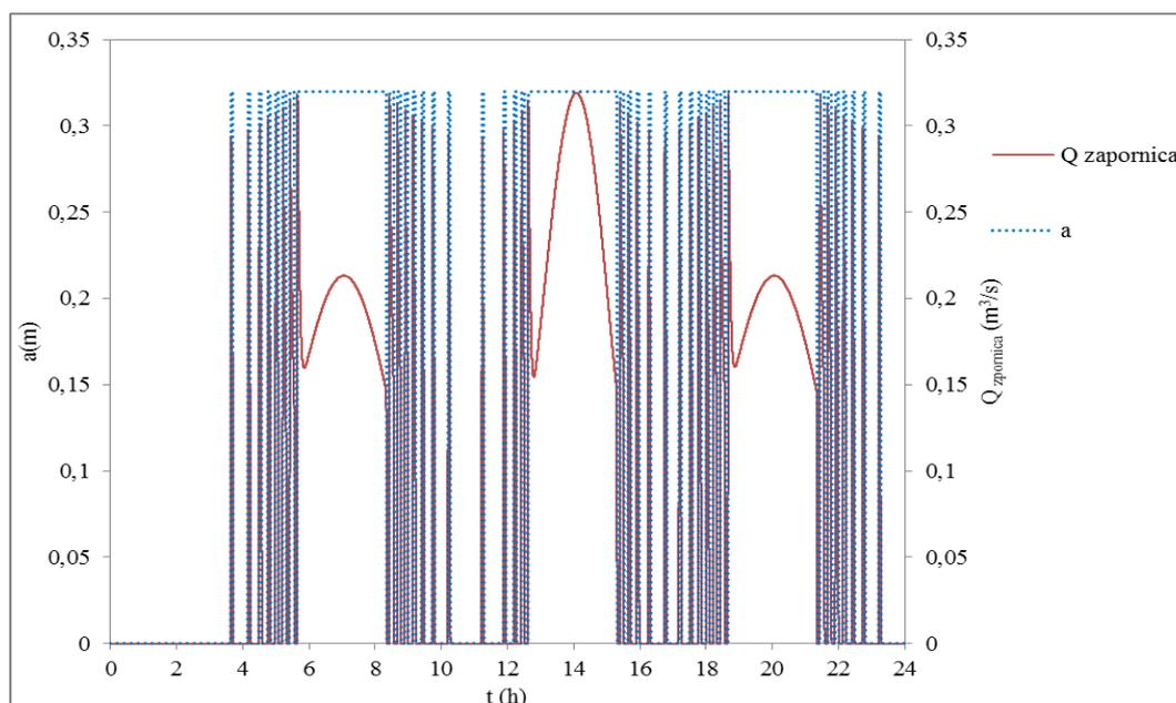
Slika 5.13. Ovisnost protoka ispod zapornice i otvorenosti zapornice
