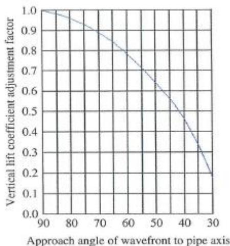
Slika 6.14. Korekcijski faktor  $F$  koeficijenta  $C_V$  u ovisnosti o kutu nailaska zrake vala u odnosu na os ispusta [7]
