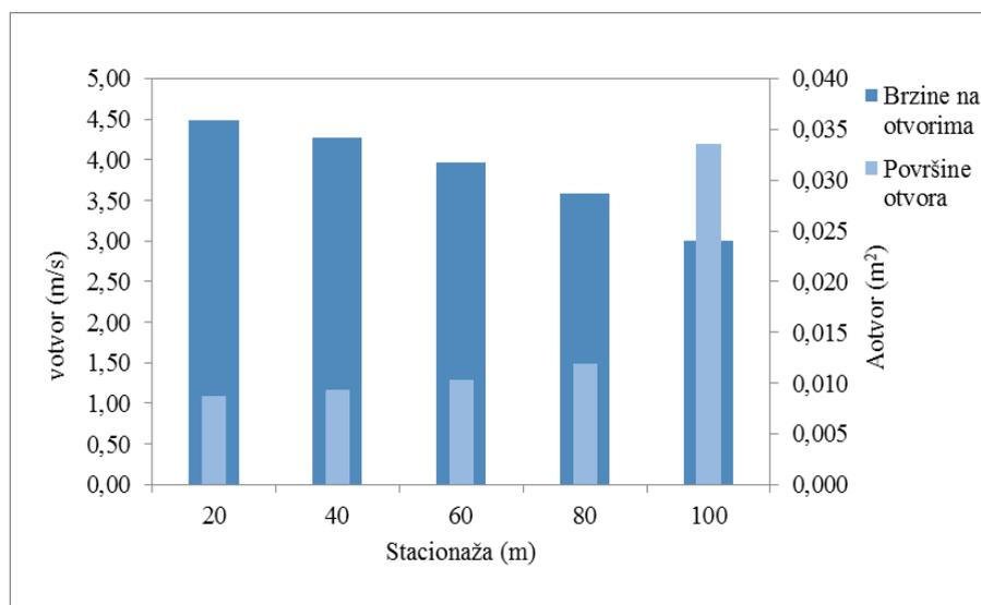
Slika 5.23. Površine otvora difuzora i istjecajne brzine na otvorima u ljetnom periodu
