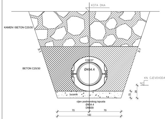
NORMALNI POPREČNI PRESJEK DIJELA PODMORSKOG ISPUSTA
