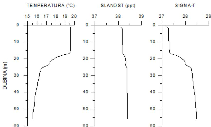
Slika 3.4. Vertikalni profili temperature, slanosti i sigma-t na postaji ASS-2 u rujnu 2001. godine [2]
