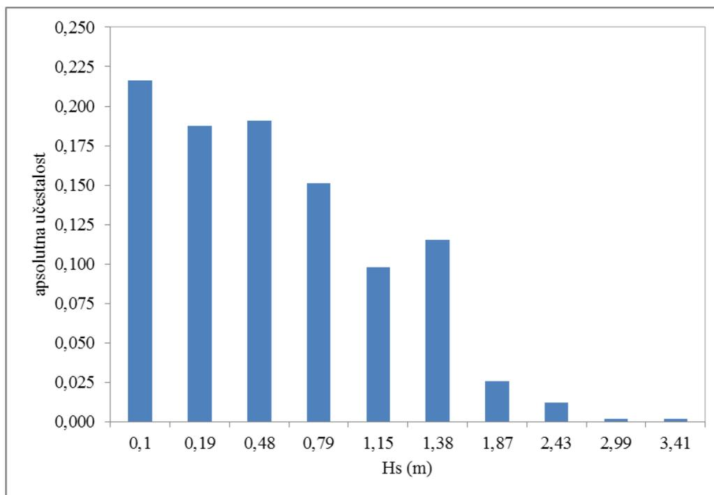
*Slika 6.4. Apsolutna učestalost pojavljivanja valnih visina (smjer SE)*
