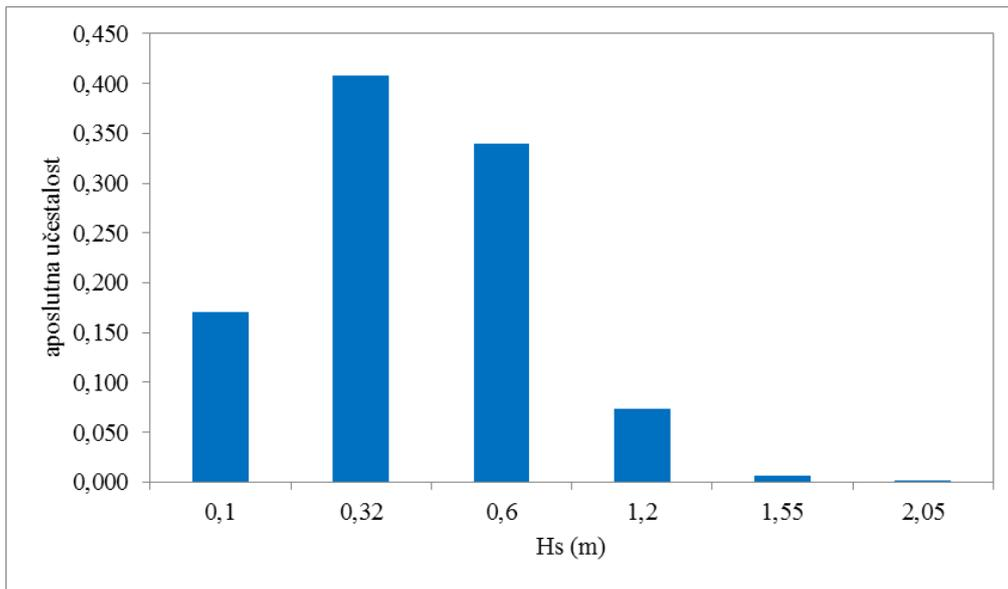
Slika 6.8. Apsolutna učestalost pojavljivanja valnih visina (smjer WSW)
