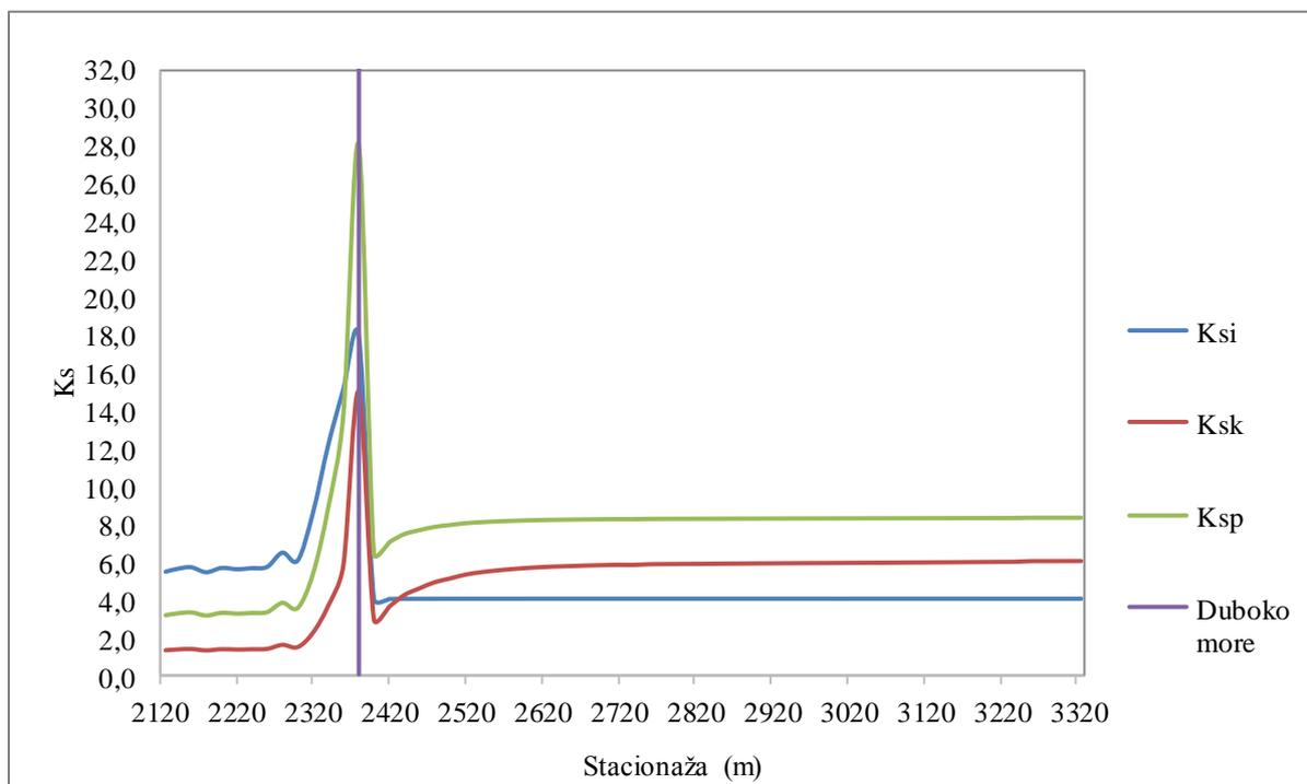
Slika 6.16. Koeficijenti stabilnosti po stacionažama podmorskog ispusta
