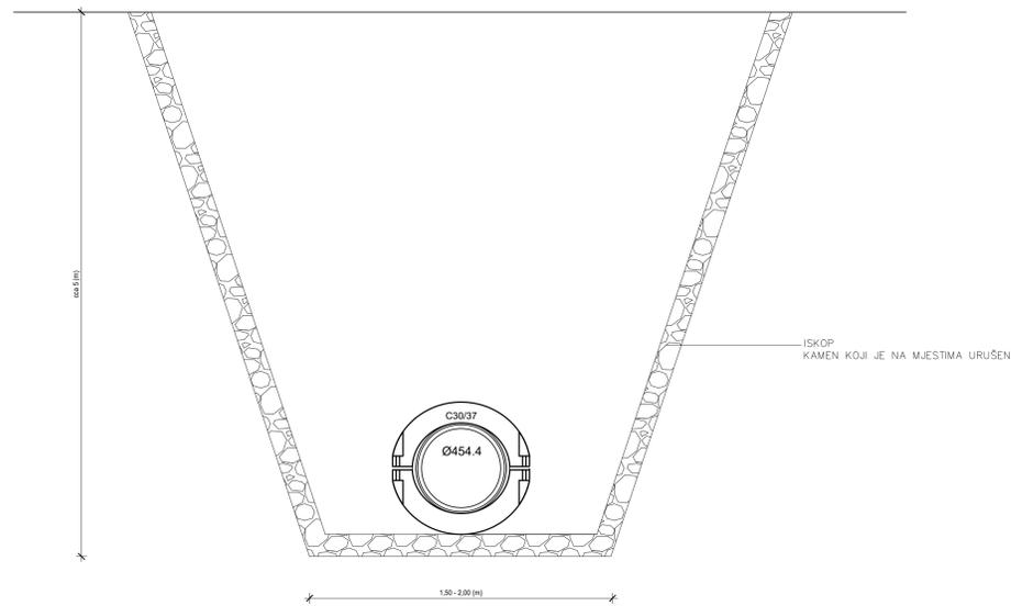
NORMALNI POPREČNI PRESJEK DIJELA PODMORSKOG ISPUSTA
