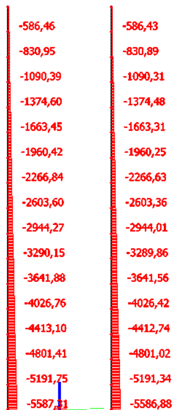
Slika .60 Osnovna kombinacija opterećenja K5 – N
