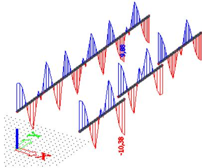
Slika 10.19 Maximalni moment savijanja  $M_y$  za kombinaciju GSU-K2 za grede  $30x30\text{cm}$
