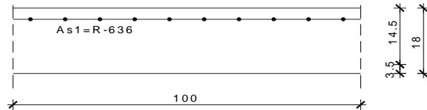
Slika 10.5. Skica armature ploče na ležaju
