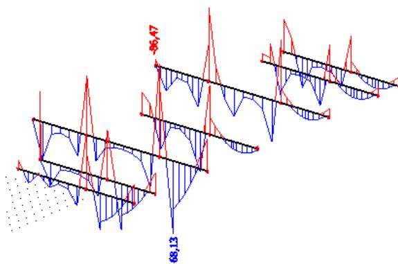
Slika 10.14. Maximalni moment savijanja  $My$  za kombinaciju GSU-K2 za grede 30x60cm
