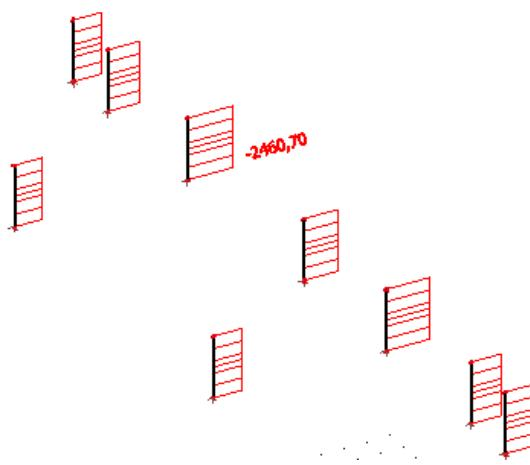
Slika 11.2. Maximalni uzdužna sila N za kombinaciju K7
