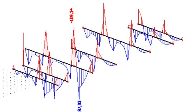
Slika 10.12 Maximalni moment savijanja  $M_y$  za kombinaciju K5 za grede 30x60 cm
