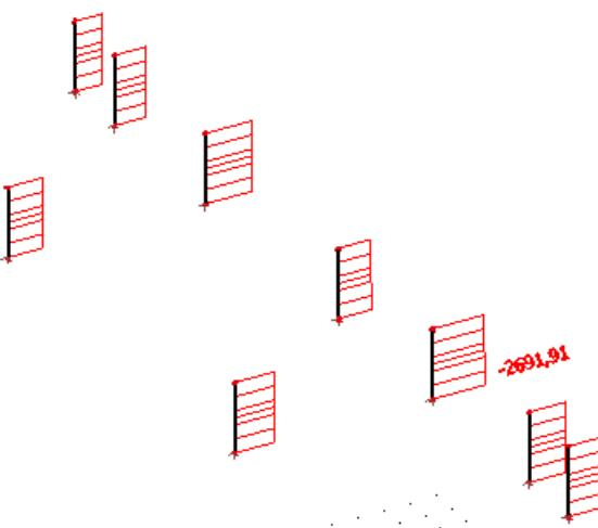
Slika 11.3. Maximalni uzdužna sila N za kombinaciju K5
