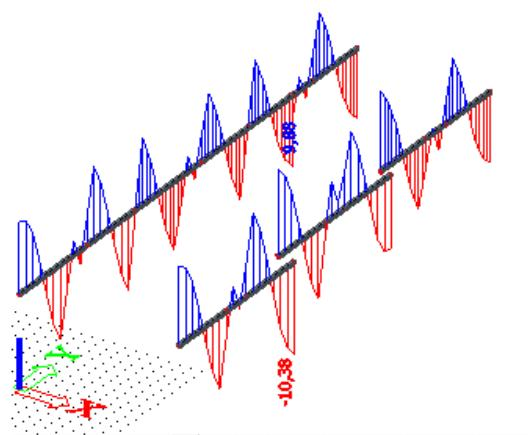
Slika 10.18. Maximalni moment savijanja  $M_y$  za kombinaciju GSU-K2 za grede 30x30 cm
