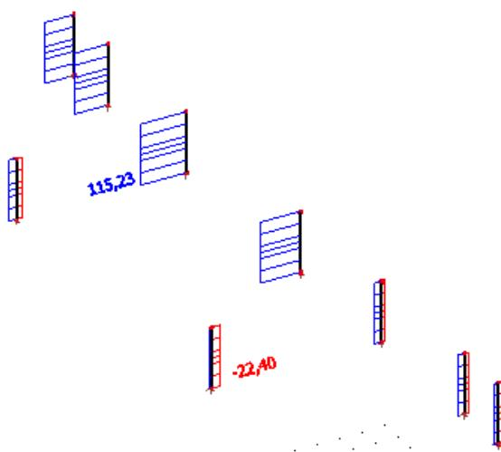
Slika 11.4. Maximalna poprečna sila V za kombinaciju K7
