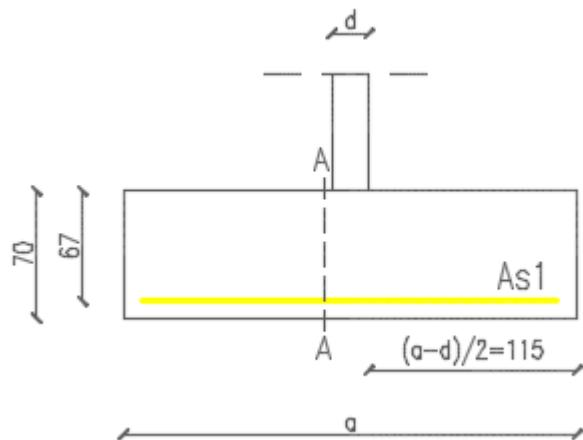
Slika 12.2. Dimenzije trakastog temelja ispod zida debljine d=30cm
