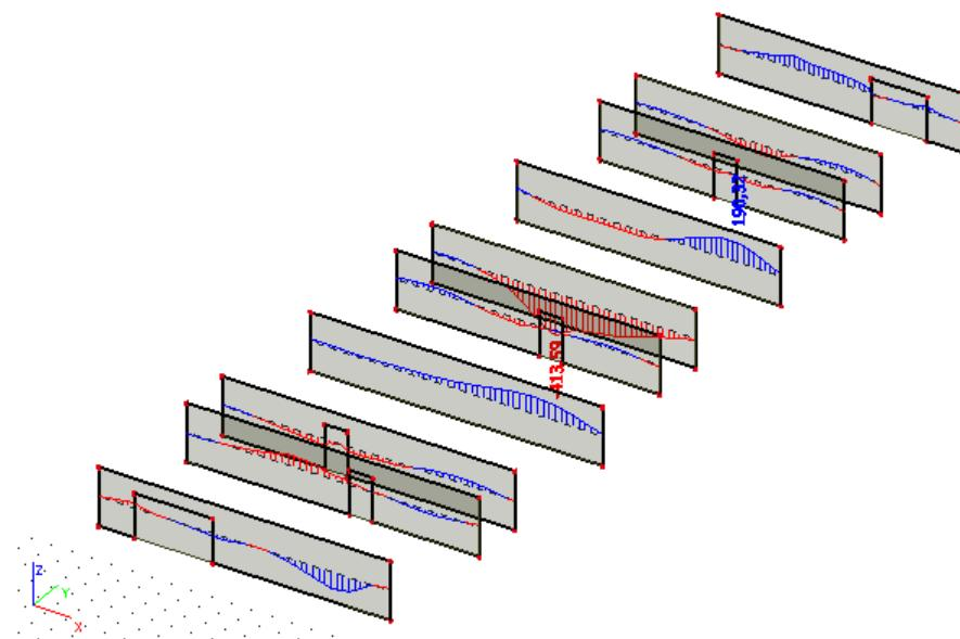
Slika 11.11. Maksimalna poprečna sila V za kombinaciju GSU-K1
