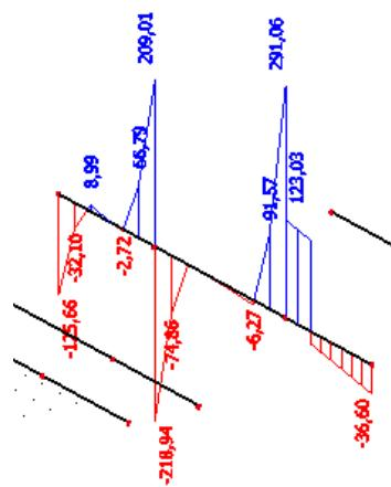
Slika 10.13 Maximalna poprečna sila za kombinaciju K5 za grede 30x60 cm
