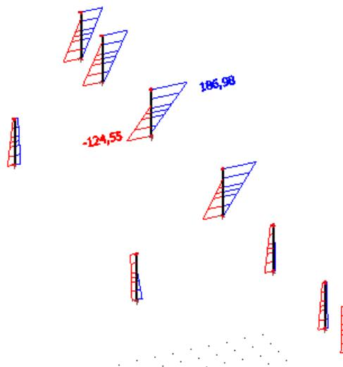
Slika 11.1. Maximalni moment savijanja  $M_y$  za kombinaciju K7
