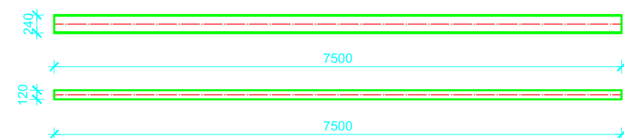
KROVNI SEKUNDARNI NOSAČI (S1-2) I IPE240, l=7500 mm, kom=20
