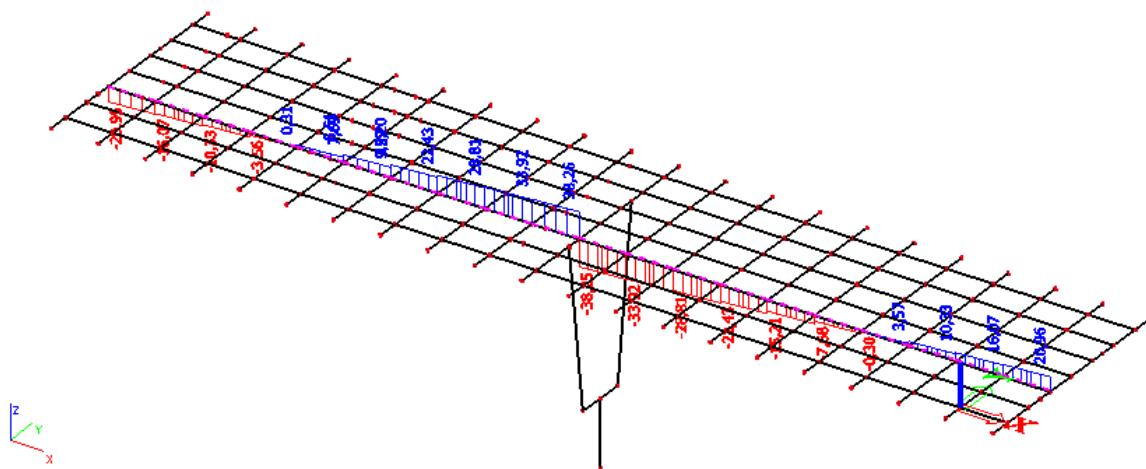
Slika 12: Dodatno stalno - poprečne sile ( $V_z$ ) u kN
