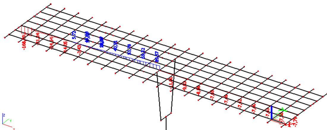
Slika 29 : Pokretno – max. poprečne sile pri upornjaku – poprečne sile ( V z ) u kN
