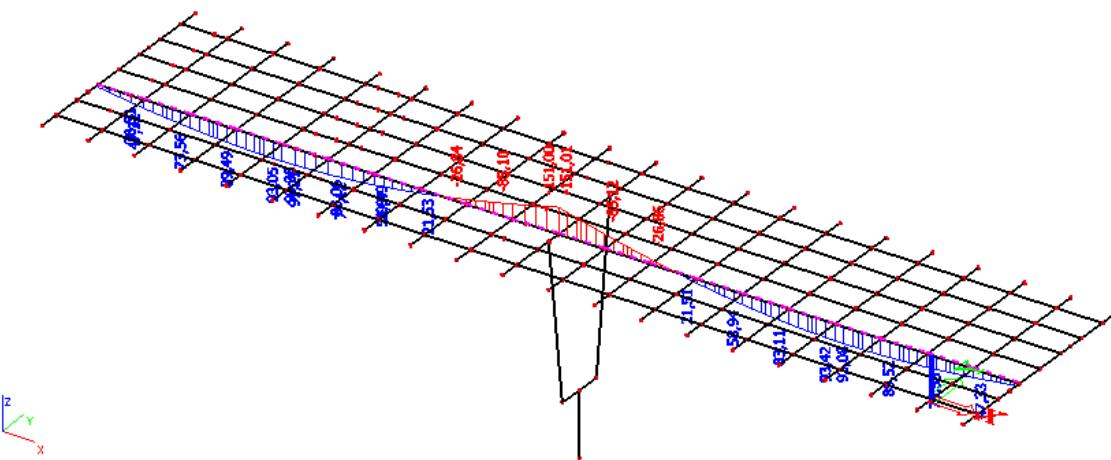
Slika 11: Dodatno stalno - momenti ( $M_y$ ) u kNm
