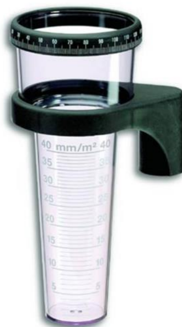
Slika 3.1 Kišomjer s brojiлом 40 mm/m 2 [11]
