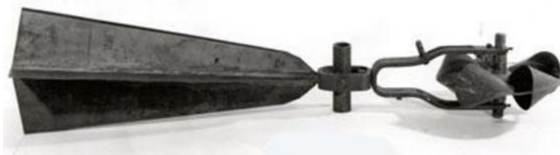
Slika 3.3 Originalno AA hidrometrijsko krilo W.G.Pricea, 1880. godina [14]
