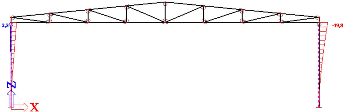
Slika 4.2.1. Horizontalni pomak rešetke uslijed mjerodavne kombinacije
