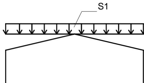
Slika 2.2.1.1. Opterećenje snijegom po cijelom nosaču
