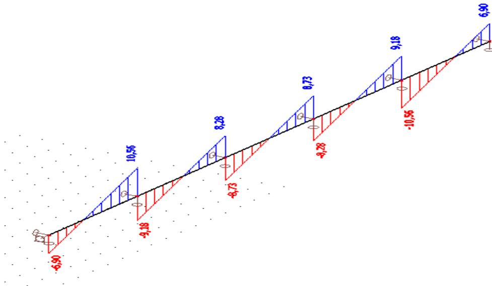
Slika 5.2.1.2. Poprečne sile  $V_z$  (kN)
