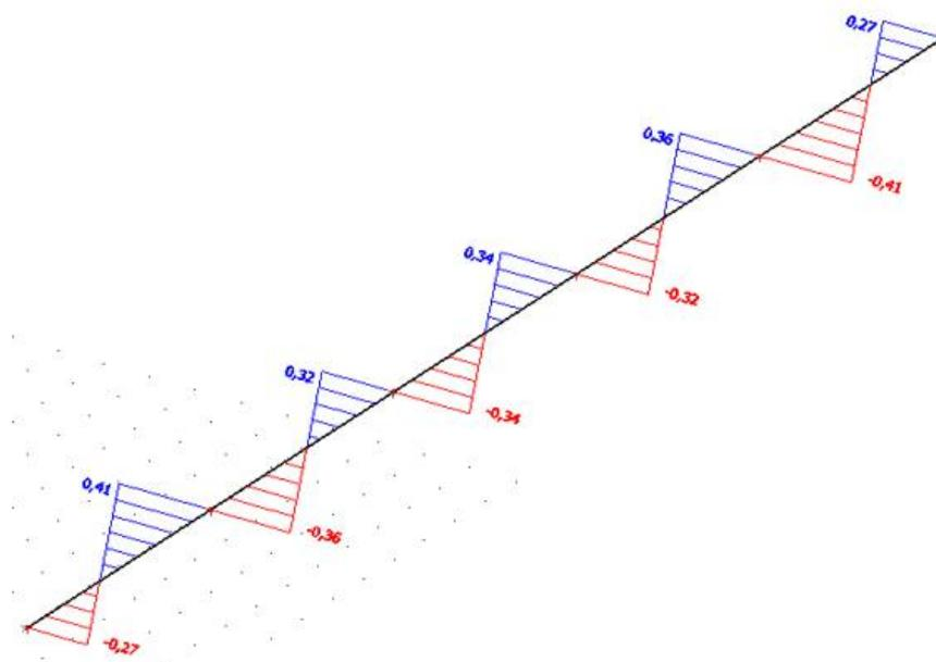
Slika 5.2.1.4. Poprečne sile  $V_y$  (kN)
