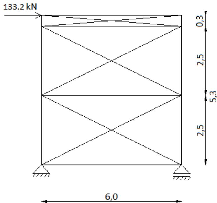
Slika 5.2.4.1. Raspored bočnih spregova i opterećenje
