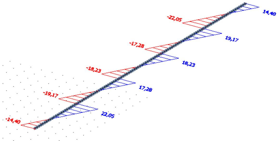
Slika 5.2.2.2. Poprečne sile  $V_z$  (kN)
