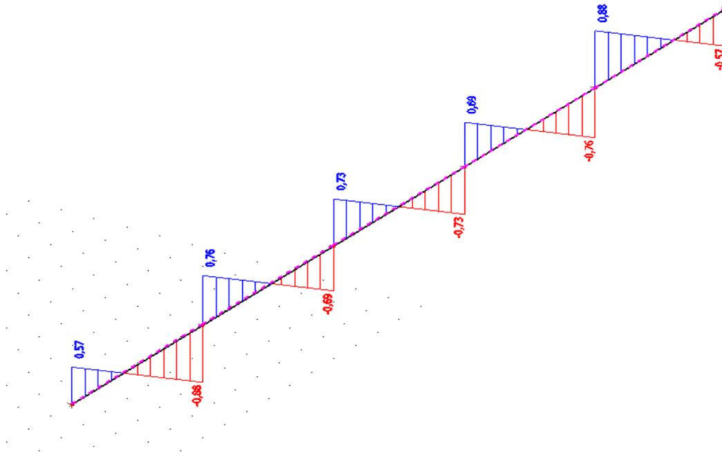
Slika 5.2.2.8. Poprečne sile  $V_y$  (kN)
