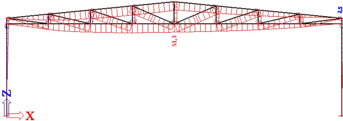
Slika 3.1.3. Vertikalni pomak rešetke uslijed mjerodavne kombinacije
