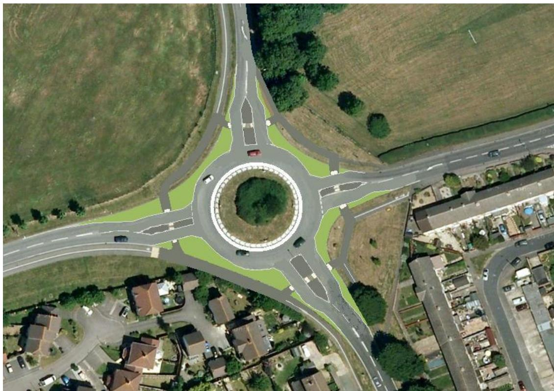
Slika 9. Gradski jednotračni kružni tok
