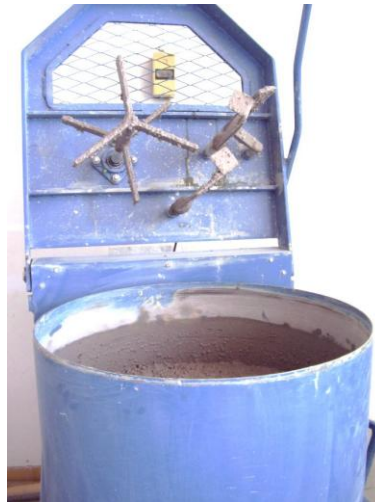
Slika 4.1. Mješalica betona [slika zabilježena tijekom ispitivanja]
