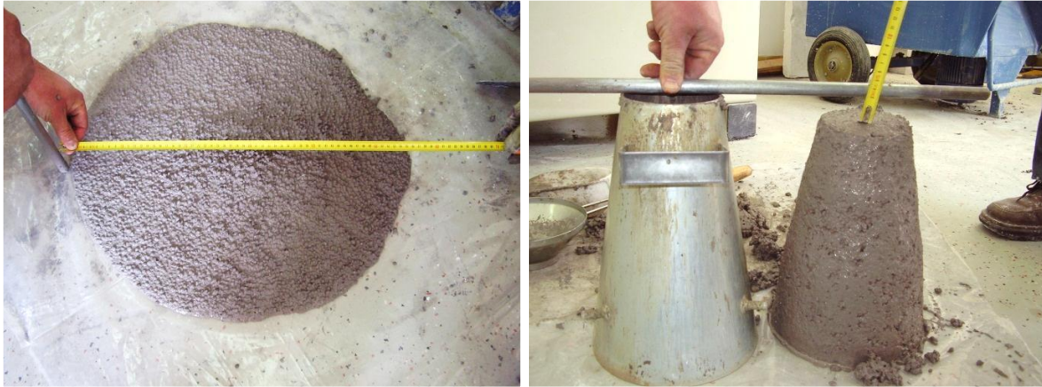
Slika 4.4. Slijeganje mješavine LB3 [slike zabilježene tijekom ispitivanja]: a) neposredno nakon miješanja, b) 30 minuta nakon miješanja
