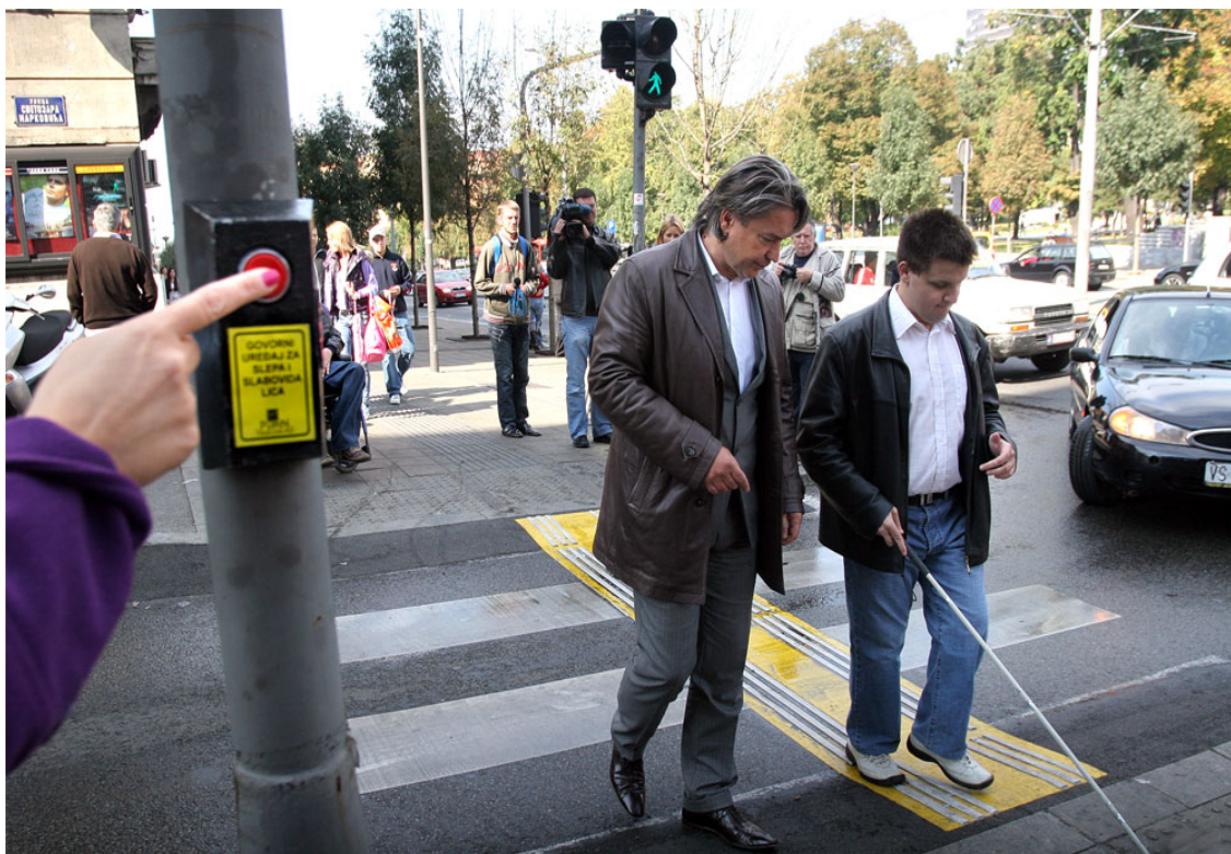
Slika 6.7. Semafor sa zvučnom signalizacijom
