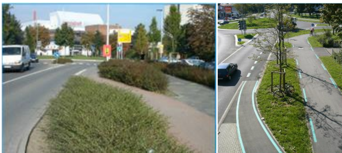
Slika 26. Usmjeravanje biciklističke staze na cestu
