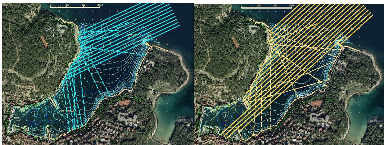
Slika 4. Zrake vala iz smjera Makarska kut  $35^{\circ}$ Slika 5. Zrake vala iz smjera Baška voda kut  $45^{\circ}$
