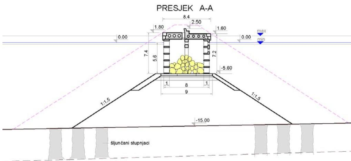
Slika 22. Poprečni presjek kombiniranog lukobrana
