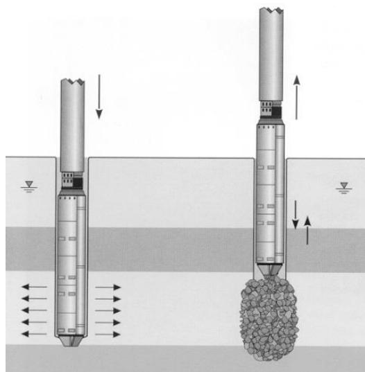
Zajedno s okolnim tlom ovakav zrnasti materijal ugrađen na opisani način, ima veću krutost i veći otpor smicanju. Ovakvo izvedeni nosivi elementi povećavaju nosivost temeljnog tla, smanjuju slijeganja i diferencijalna slijeganja koja su često ograničavajući parametar pri projektiranju temeljenja. Zbog velike vodopropusnosti šljunčanih stupnjaka dolazi do ubrzanja vremena konsolidacije i povećanja posmične čvrstoće temeljnog tla.
