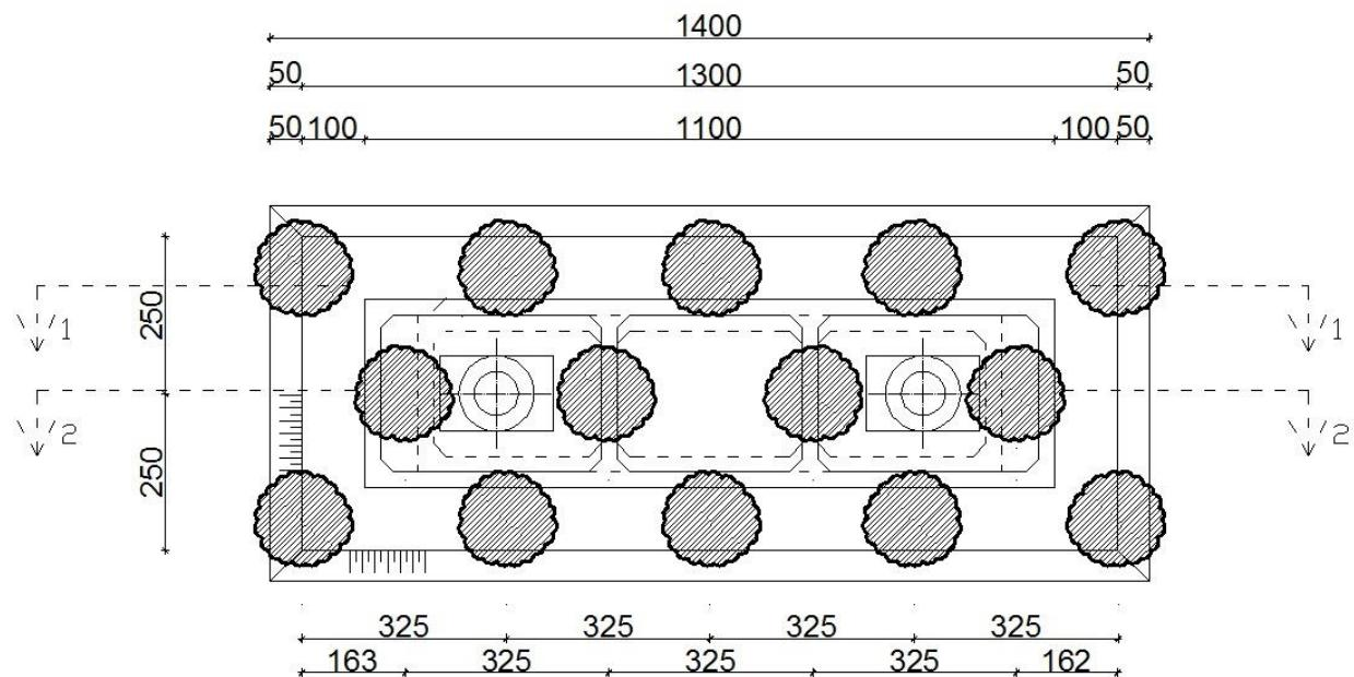
Slika 32. Tlocrt šljunčanih stupnjaka ispod temeljnog nasipa
