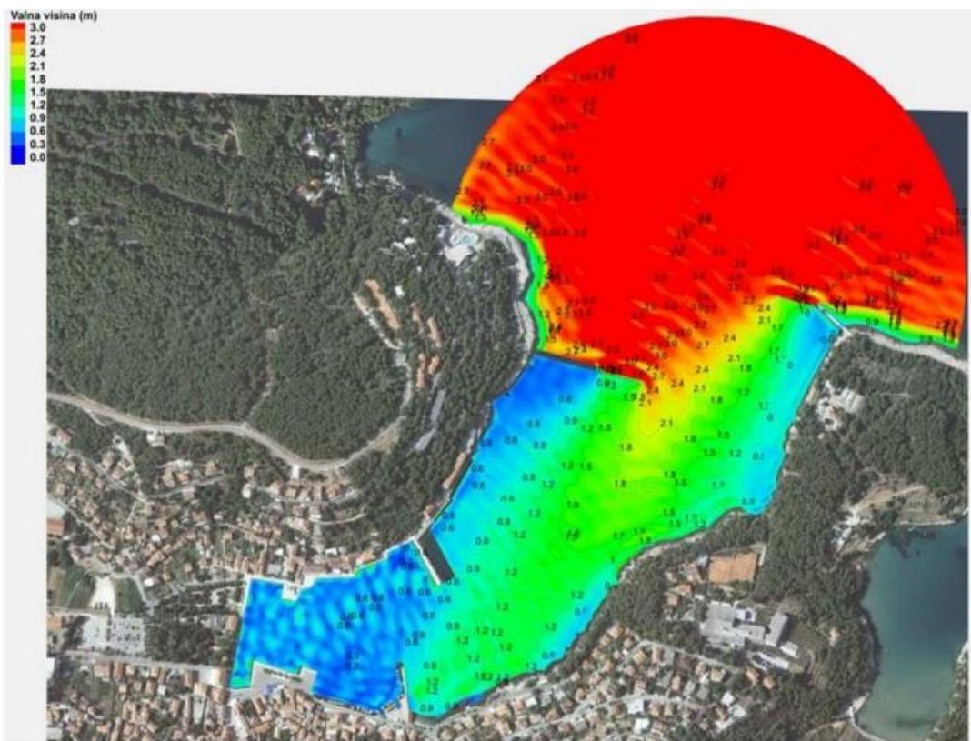
Slika 10. Polje značajnih valnih visina za simulaciju varijantnog rješenja lukobrana Sv. Antonij i povratnog perioda 100g iz incidentnog smjera NE  $45^{\circ}$
