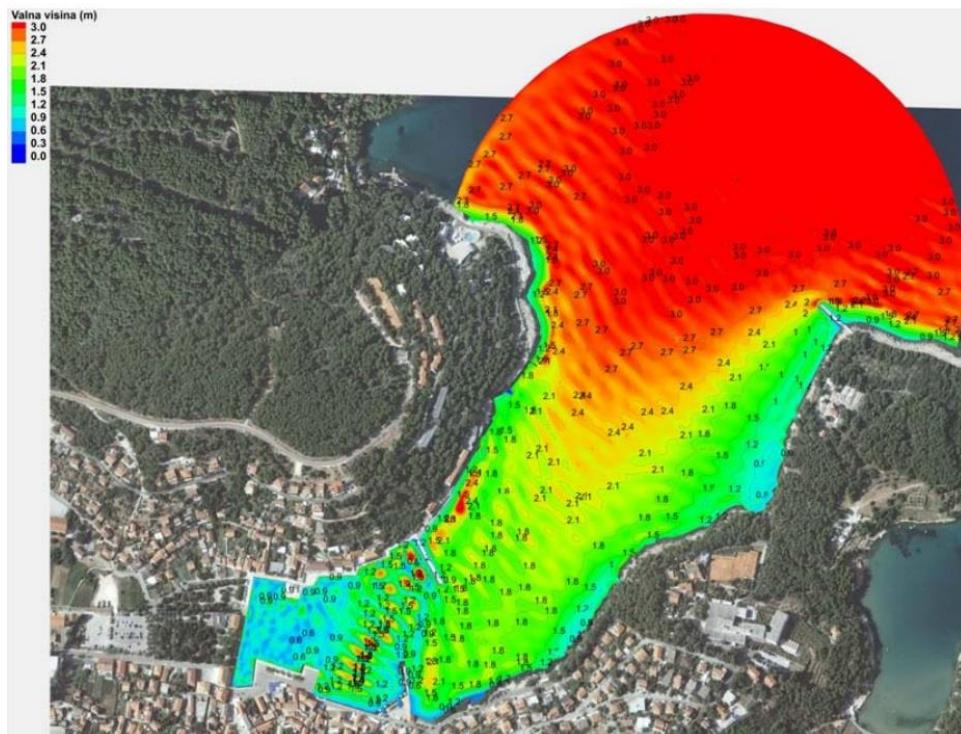
Slika 9. Polje značajnih valnih visina za simulaciju postojećeg stanja i povratnog perioda 100g iz incidentnog smjera NE  $45^\circ$
