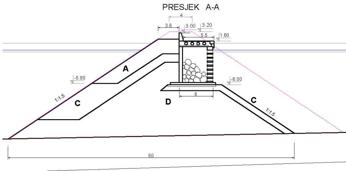
Slika 20. Poprečni presjek nasutog lukobrana s pristanom
